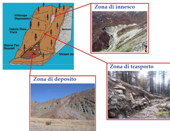
**Figura 2.2** - Esempio di flusso incanalato dove si distinguono una zona d'innesco, di trasporto e di deposito (Pirulli, 2014)
