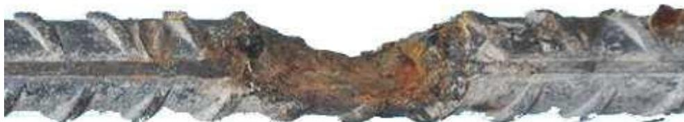
Figura 1.4 – Corrosione per pitting
