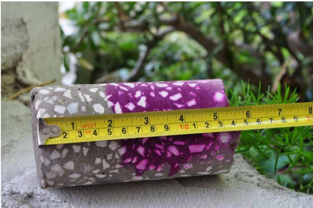
Figura 1.5 – Determinazione del fronte carbonatato mediante fenolftaleina
