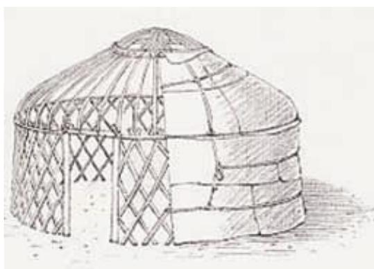
*Figura 1-6 : Yurt mongolo. Schema degli elementi costruttivi che compongono uno yurt.*
