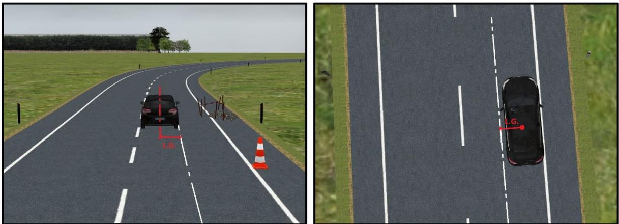
*Figura 19. Rappresentazione della grandezza Lane Gap (L.G.): in prospettiva a sinistra e visto dall'alto a destra.*
