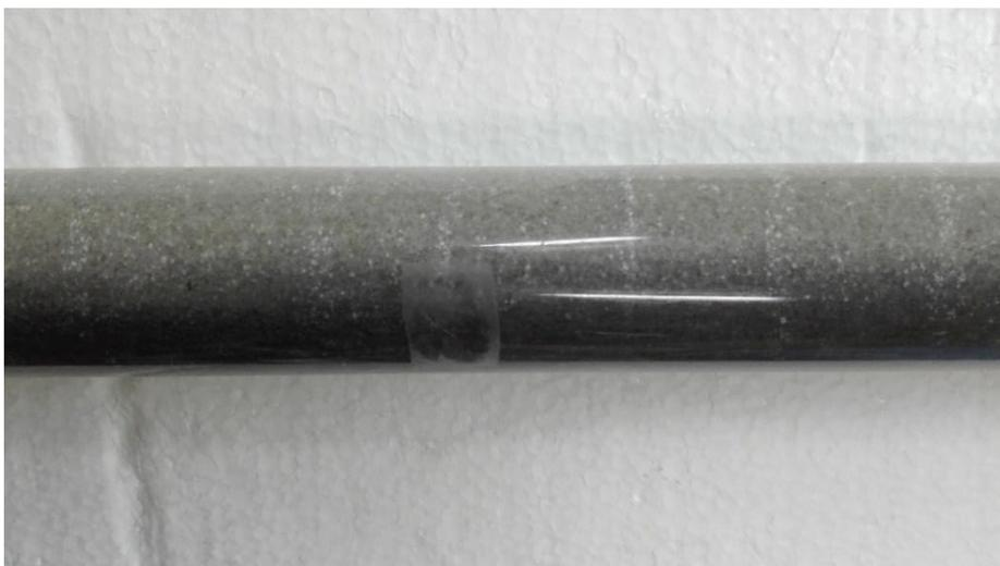
Figura 92. Sedimentazione del ferro all'interno della colonna a prova conclusa.
