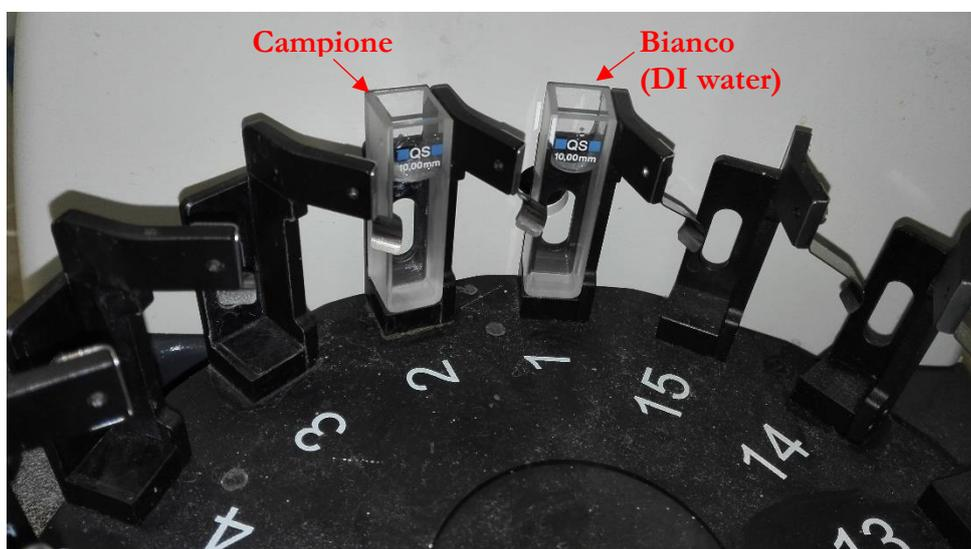
Figura 45. Disposizione dei campioni nello spettrofotometro.
