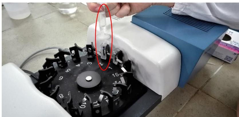
Figura 61. Utilizzo del filtro per le misurazioni allo spettrofotometro.
