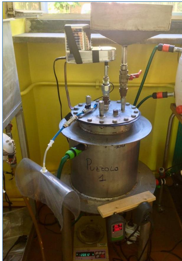
*Figura 6.2 – Boiler per il mantenimento della temperatura di processo*
