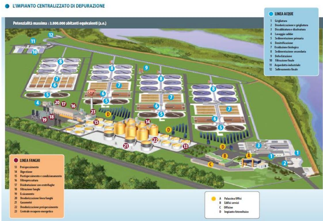
Nello specifico, come si può osservare in *Figura 1.1*, l'impianto è dotato di quattro moduli, operanti in parallelo, per il processo di depurazione delle acque, e di una linea per il trattamento dei fanghi.
