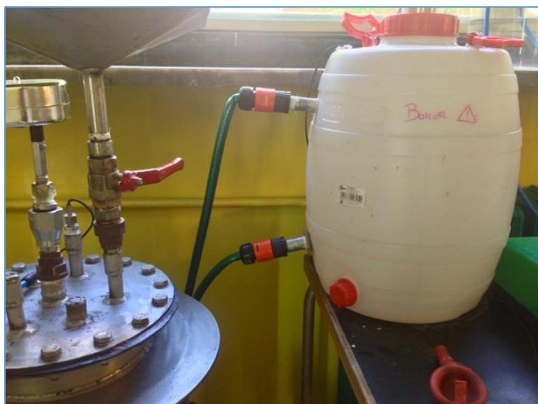
Il digestore è incamiciato così da poter permettere il passaggio tra le pareti dell'acqua, che è riscaldata attraverso una resistenza posta nel boiler. Il controllo elettronico misura in tempo reale la temperatura interna del digestore, attivando e disattivando la pompa di ricircolo dell'acqua calda. Contemporaneamente viene comandata la resistenza presente nel boiler al fine di mantenere l'acqua alla temperatura desiderata.
