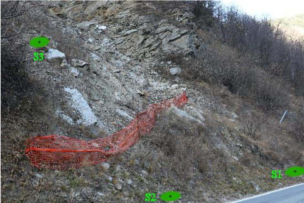
Figura 45 – Posizionamento sondaggi nella parte bassa
