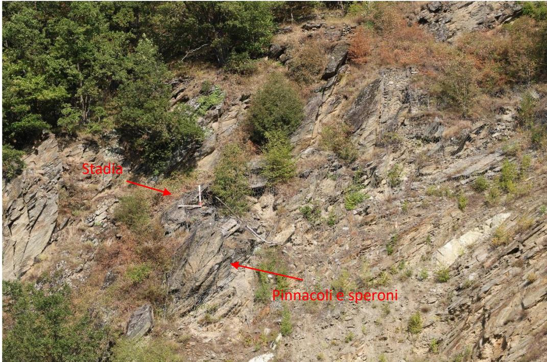
Figura 22 – Zona a sinistra della conca in cui sono visibili i pinnacoli fratturati e le altre zone limitrofe a pendenza minore; è inoltre presente una stadia posizionata durante il rilievo geomeccanico
