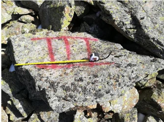
figura 5.11 – Blocco di riferimento della classe III (0,181 m<sup>3</sup>). La lunghezza riportata dal metro è di 0,5 m
