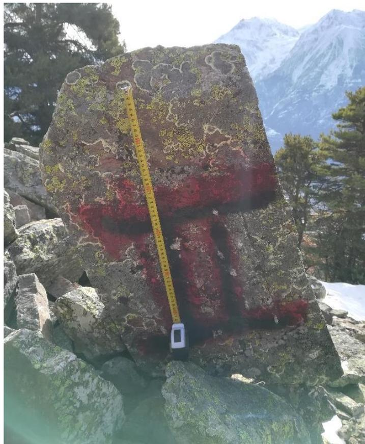
figura 5.10 – Blocco di riferimento per la classe II ( $0,064 \text{ m}^3$ ). La lunghezza riportata dal metro è di 0,5 m
