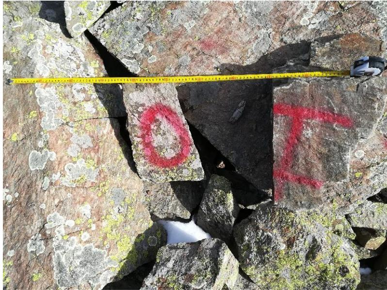
figura 5.9 – Blocchi di riferimento per la classe 0 ( $0,008 \text{ m}^3$ ) e per la classe I ( $0,023 \text{ m}^3$ ). La lunghezza riportata sul metro è di 1 m
