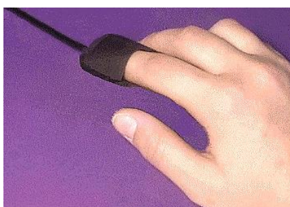
Figura 24. Rappresentazione del sensore fotoplethismografico
