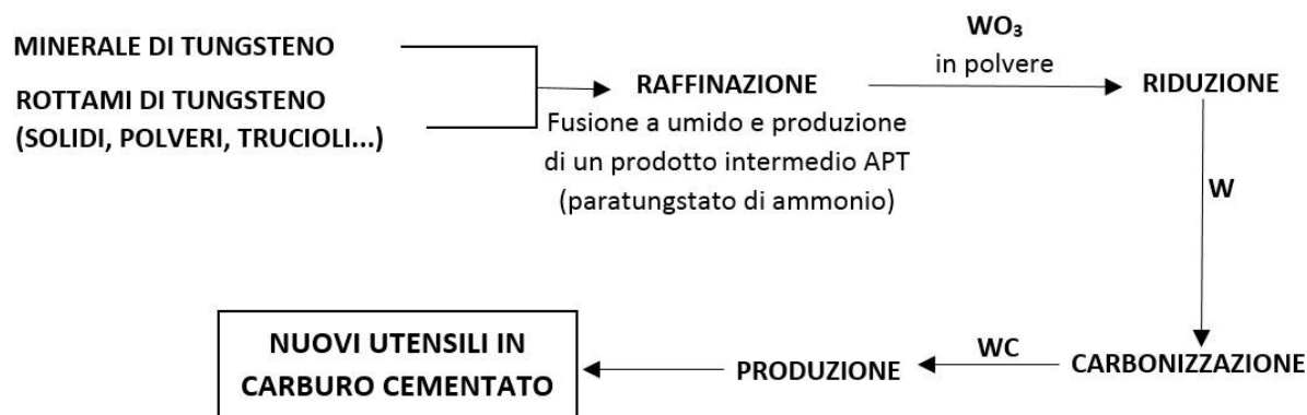
Figura 8: Schema del processo di riciclaggio del tungsteno.
