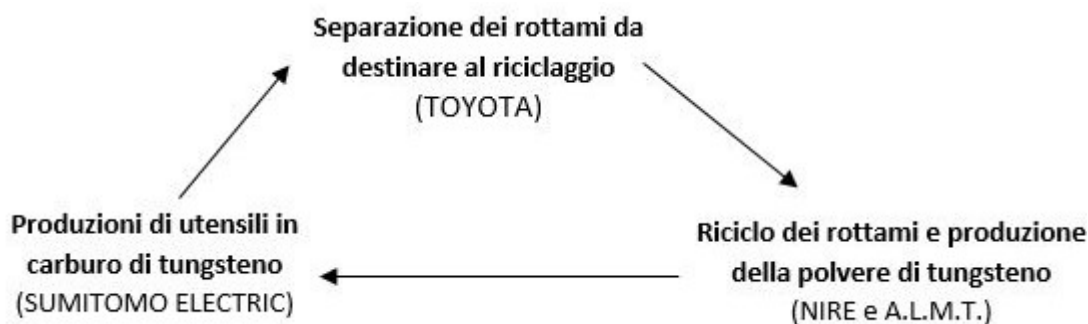
Figura 10: Schema che illustra la chiusura del ciclo del riciclaggio dei rottami in tungsteno.
