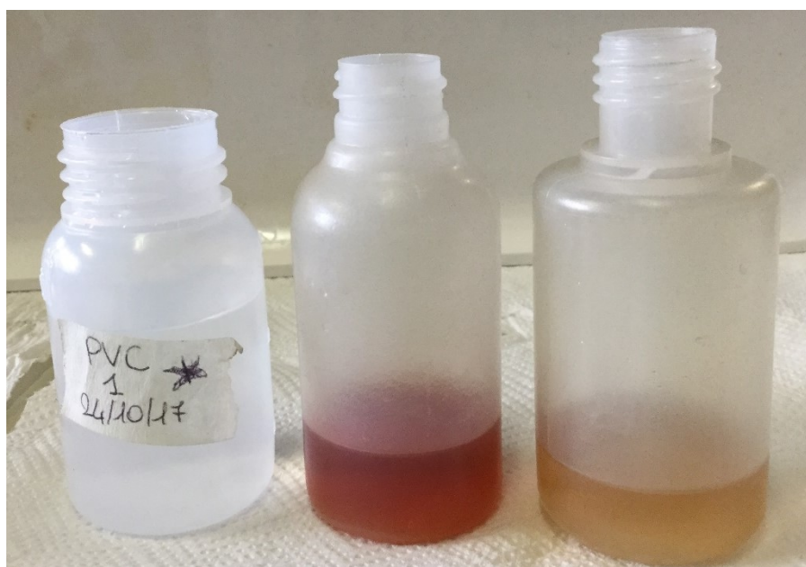
Figura 48: Soluzioni realizzate a partire da un campione della serie PVC, il campione centrale è quello non diluito e quello a destra è quello diluito
