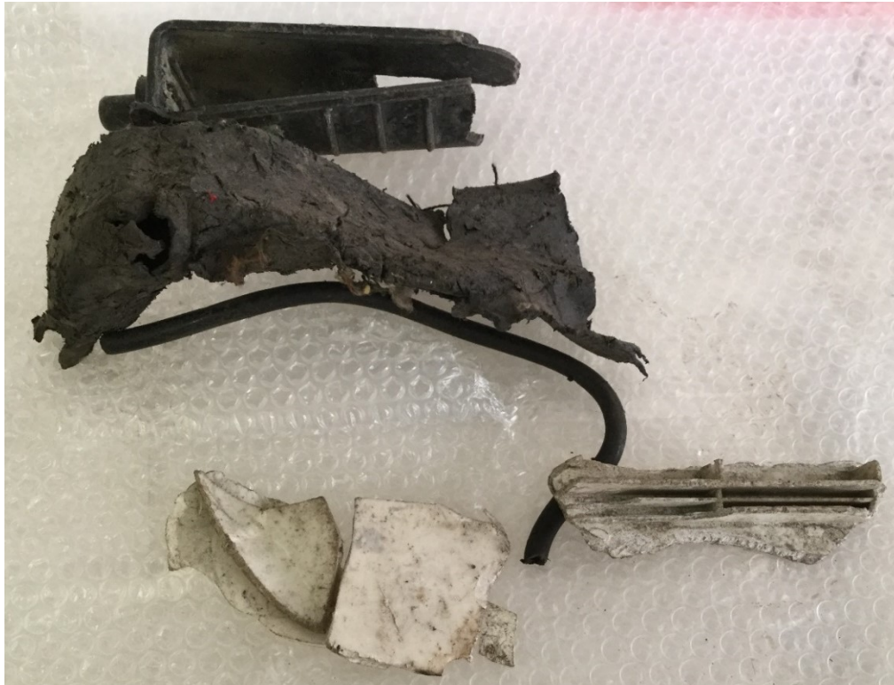
Figura 36: Parti provenienti dalla frazione di plastica del fluff leggero frazione pesante di aprile '17 non rammollite a 170°C
