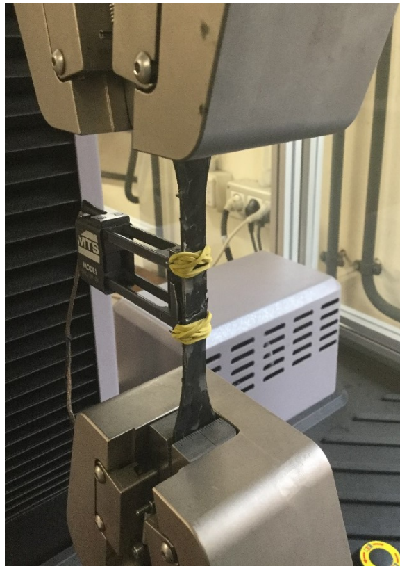
Figura 57: Provino sottoposto alla prova di trazione rotto correttamente.
