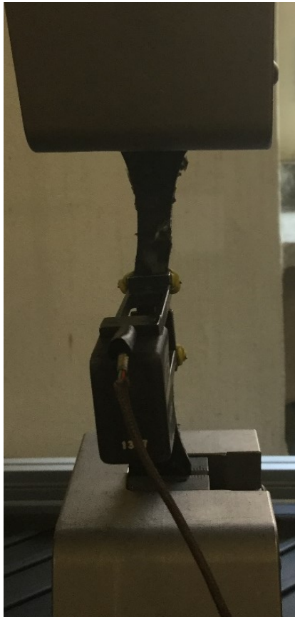
Figura 58: Provini sottoposti alla prova, rotti al di fuori del tratto utile.
