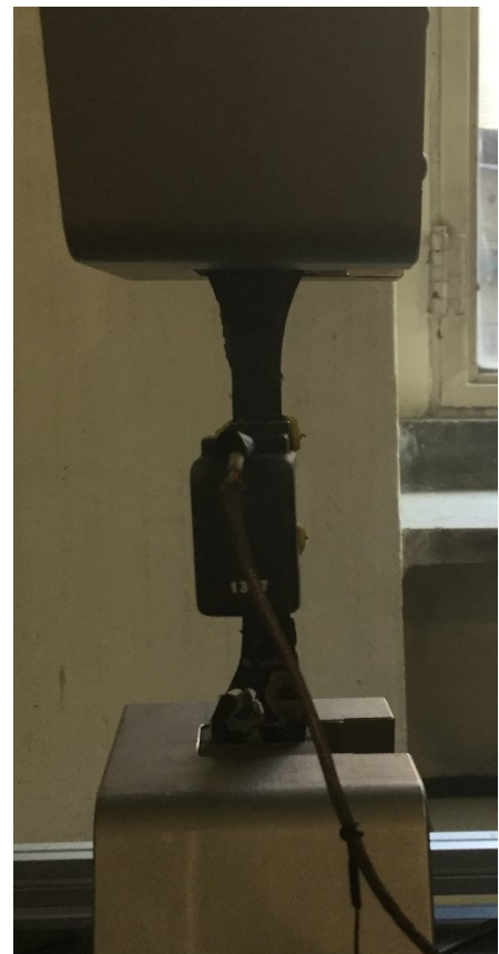
Figura 58: Provini sottoposti alla prova, rotti al di fuori del tratto utile.
