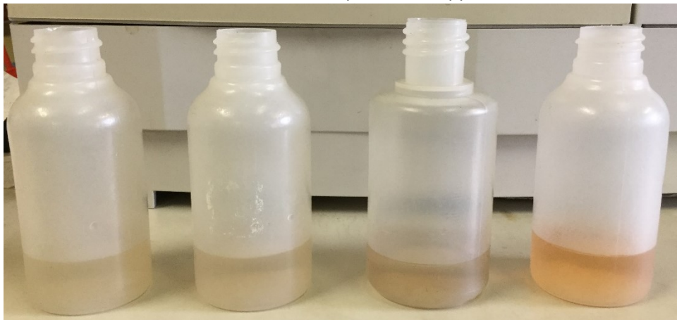
Figura 47: Campioni utilizzati per realizzare la retta di taratura per misurare la concentrazione di cloruri, da sinistra a destra si passa dal meno concentrato al più concentrato.
