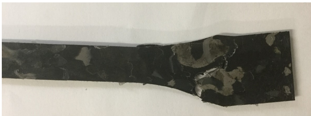
Figura 59: Dettaglio di un provino rotto al di fuori della zona utile.
