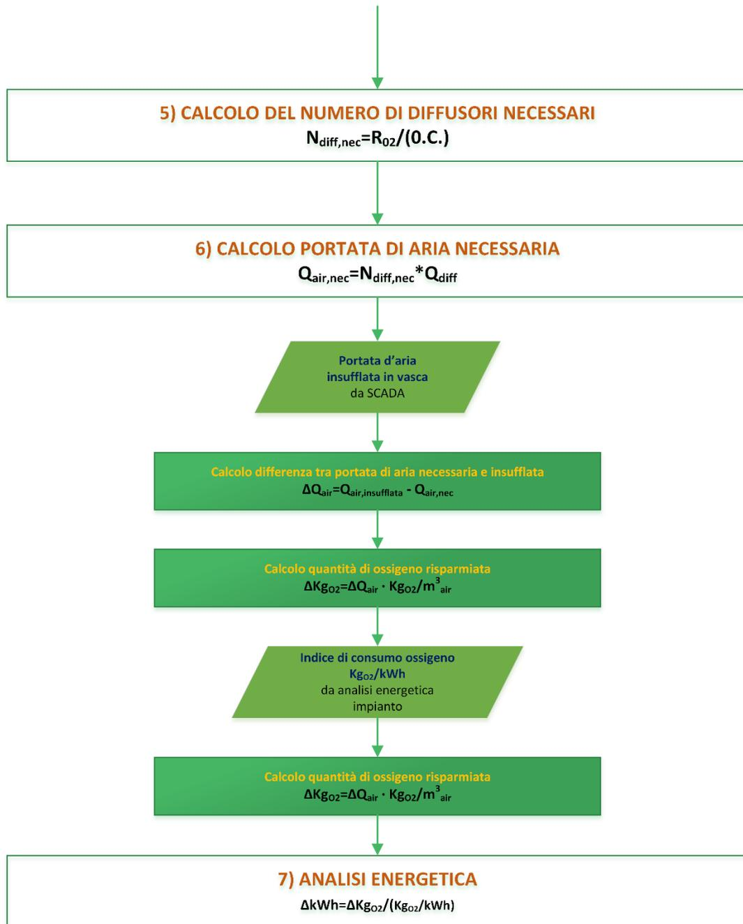
Figura 3.30 Diagramma di flusso del modello di calcolo messo a punto per la verifica energetica delle vasche di aerazione.
