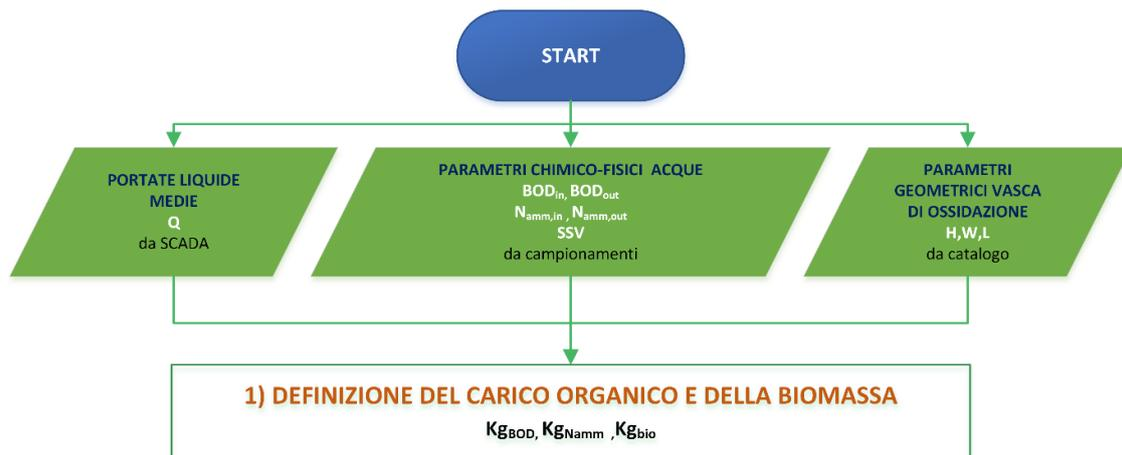
Figura 3.31 Rappresentazione grafica del primo step di calcolo.
