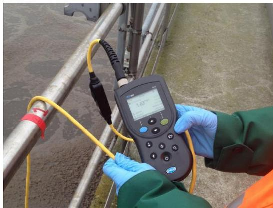
**Figura 3.27 Sonda portatile di misura dell'ossigeno disciolto del tipo multimetro digitale a canale singolo HACH, model number HQ30D (Di Rosa A., 2017).**
