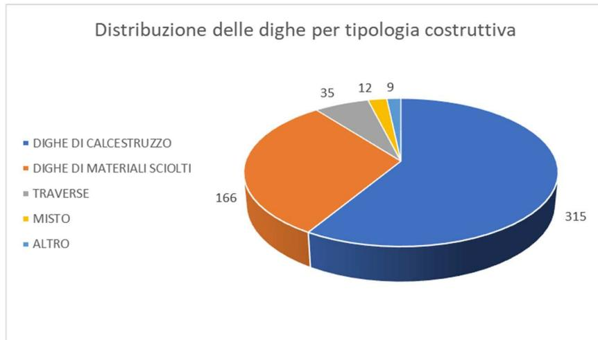
Figura 42 - Distribuzione delle dighe per tipologia costruttiva
