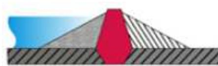
*Figura 36 - Schema trasversale di una diga in terra e/o pietrame con struttura di tenuta interna*
