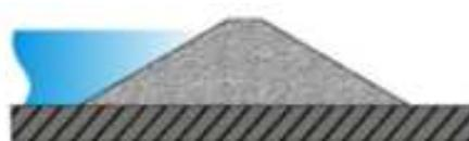
Figura 34 - Schema trasversale di una diga in materiali sciolti
