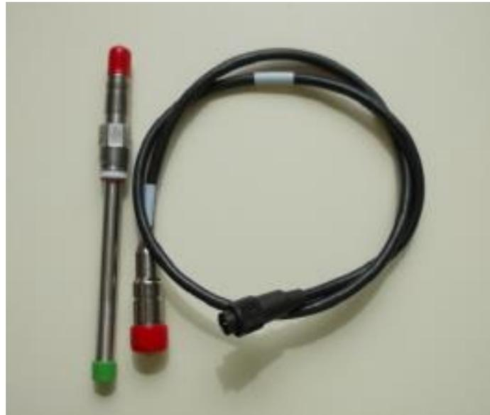
**Figura 2.12:** Sonda per la misura della concentrazione di ossigeno disciolto.
