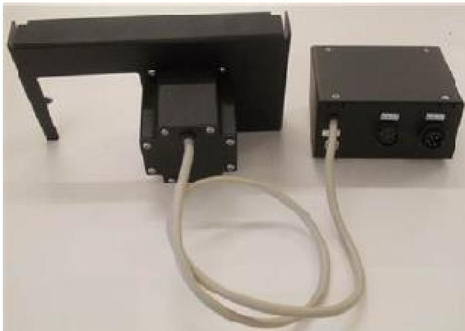
**Figura 2.8:** Motore magnetico esterno, con l'alimentazione e il supporto per il fissaggio al corpo del fotobioreattore.
