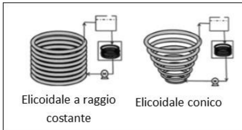
**Figura 1.4:** Esempi di fotobioreattori elicoidali nella configurazione a raggio costante (sinistra) e conica (destra). Entrambe le schematizzazioni presentano il flusso in movimento dal basso verso l'alto, una pompa di movimentazione e una zona di disimpegno esterna. (Figura tratta da (Dasgupta et al., 2010) con modifiche)
