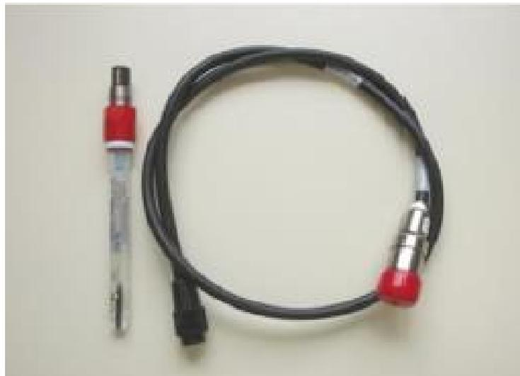
**Figura 2.11:** pH-metro con sonda integrata per la misura della temperatura.
