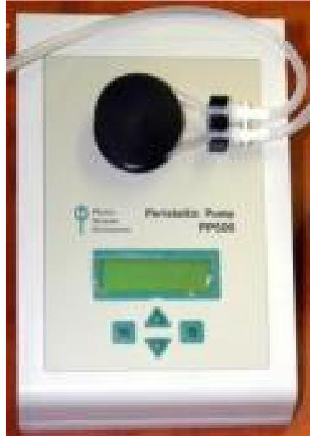
**Figura 2.10:** Pompa peristaltica per la movimentazione fluidica.
