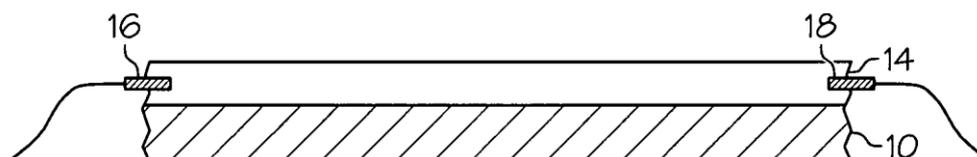
*Figure 30: Parete su cui è applicata la vernice conduttiva alimentata con elettrodi*
