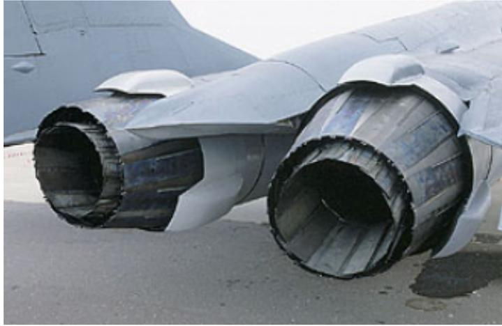
Figura 1.2: Esempio di ugelli orientabili.
