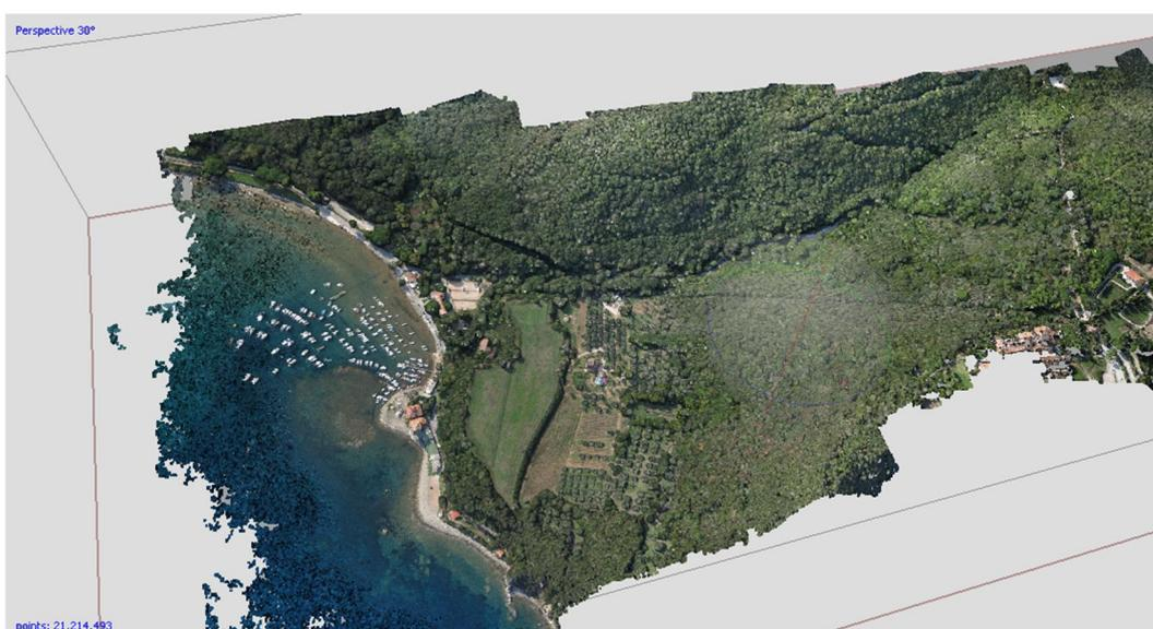
*Figura 33\_Nuvola densa di punti generata tramite software Agisoft Photoscan.*
