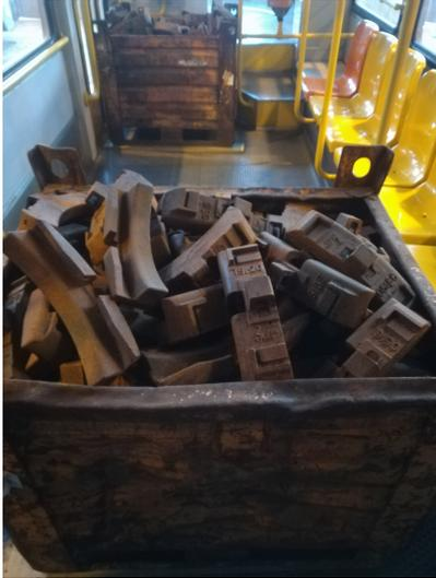
Figura 5.1: Cassoni utilizzati per zavorrare la motrice 5051
