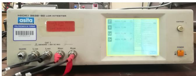
Figura 3.1: Impedenzometro Hioki 3532-50 LCR HiTESTER
