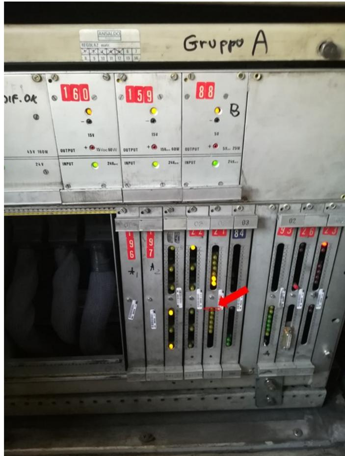
Figura 3.5: Regolatore chopper dell'azionamento A della motrice 5047
