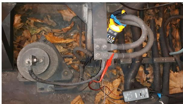
Figura 5.12: Posizionamento della pinza amperometrica e della sonda di tensione sull'imperiale della motrice 6031
