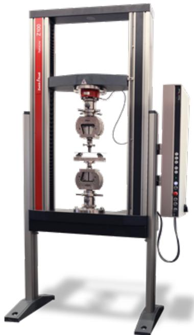
**Figura 4.19:** macchina per prove di trazione Zwick Z100[33]
