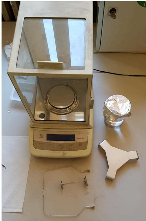
**Figura 4.9:** Bilancia Orma model BC con relativo sistema per il metodo Archimede
