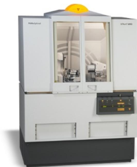
**Figura 4.16:** macchina per la diffrazione di raggi X Panalytical Xpert [29]
