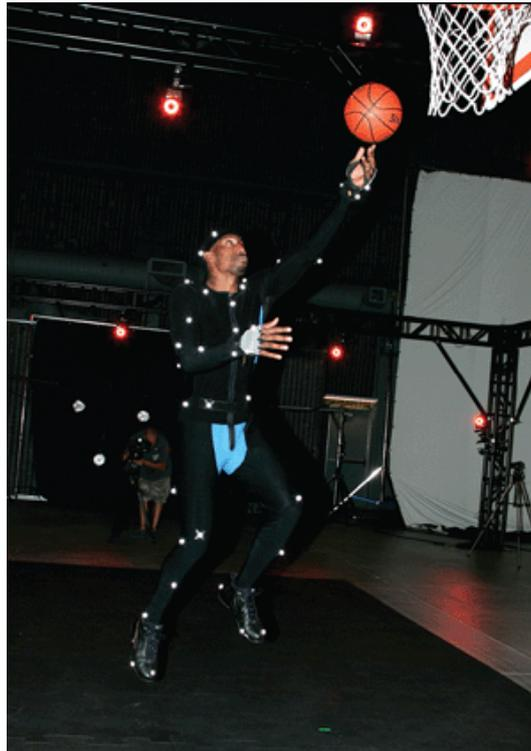
Figura 1.4: Lo studio di motion capture della Sony Computer Entertainment America a San Diego basato su sistemi di motion capture ottici con marker passivi per la registrazione delle animazioni di atleti e attori da utilizzare nei giochi per Playstation 3
