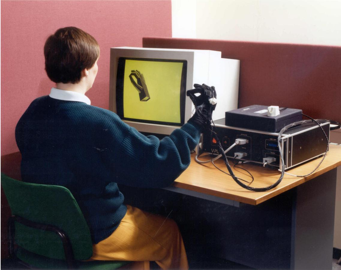
Figura 2.3: Riproduzione di una gesture su schermo tramite il DataGlove della VPL Inc.
