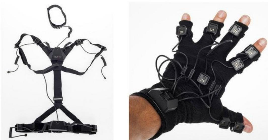
Figura 4.10: A sinistra la struttura a strappi indossabili della tuta, a destra il dettaglio del guanto <http://www.moguravr.com/perception-neuron-sale-japan/>
