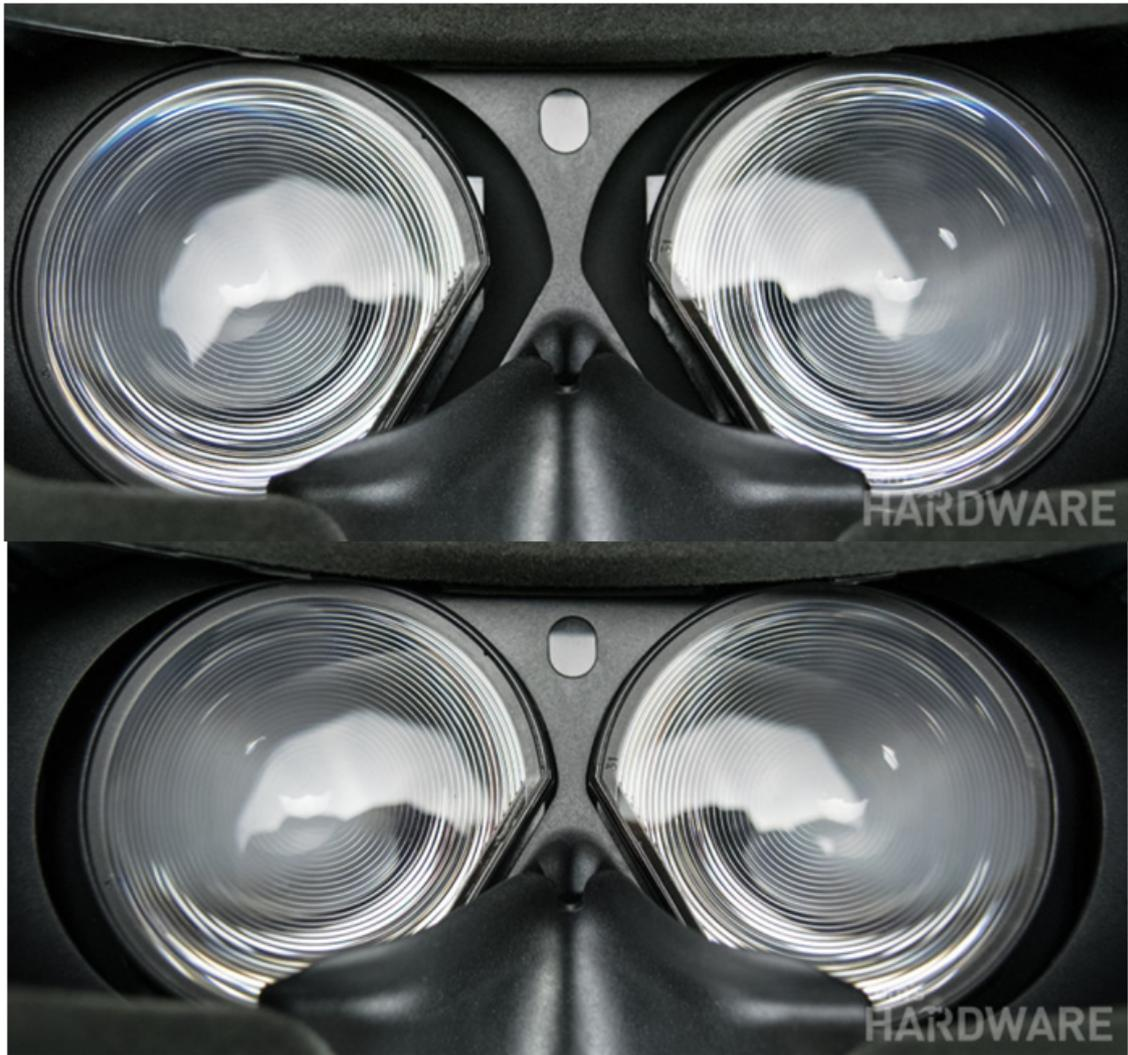
Figura 4.3: HTC Vive: in dettaglio le lenti Fresnel del HMD con differenti impostazioni di IPD.
