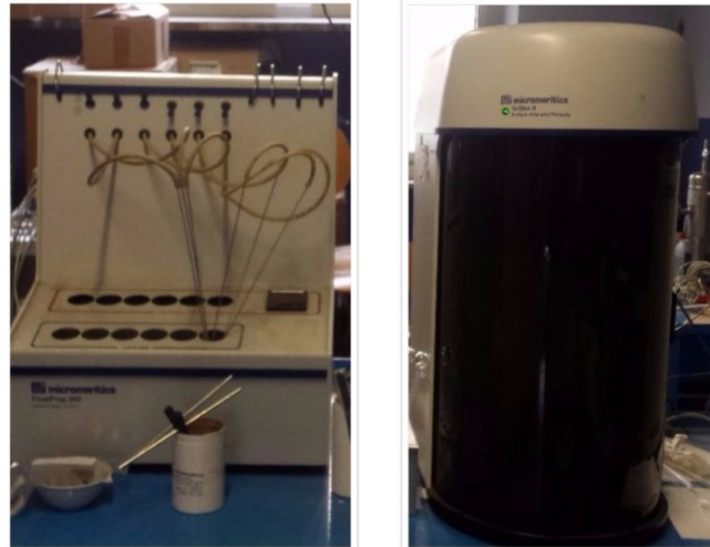
Figura 3.1: A sinistra, Micromeritic FlowPrep 060 per il degasaggio dei campioni, a destra, Micromeritics TriStar II Asap 3020 per il test.
