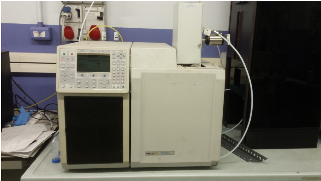
Figura 4.2: gascromatografo Varian CP-3800.
