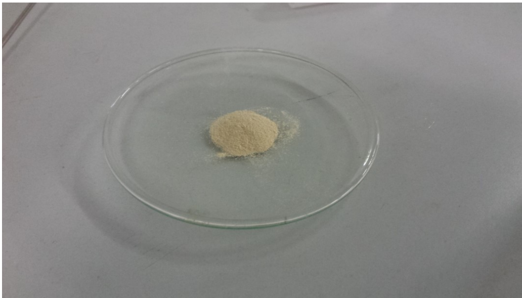
Figura 2.4: particolare della polvere di titania dopata con azoto (N-TiO 2 ) ottenuta con metodo sol-gel.
