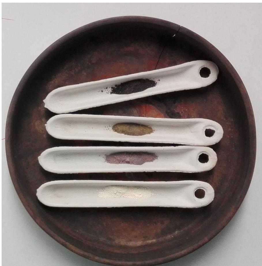
**Figura 2.5:** Campioni pronti per l'invecchiamento. Dall'alto in basso:  $\text{Ce}_{95}\text{Mn}_{2.5}\text{Cu}_{2.5}$ ,  $\text{Ce}_{95}\text{Cu}_5$ ,  $\text{Ce}_{95}\text{Mn}_5$ ,  $\text{CeO}_2$ .
