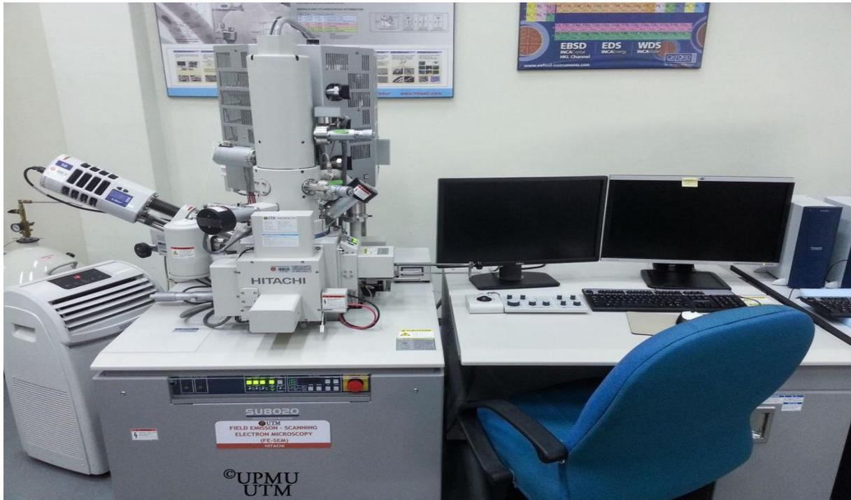
**Figura 3.7:** Microscopio elettronico a scansione ad emissione di campo.
