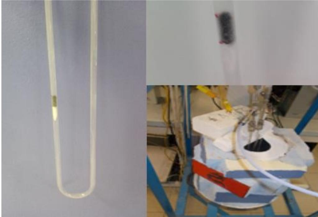
**Figura 3.13:** Reattore e forno impiegati nelle prove di attività catalitica.
