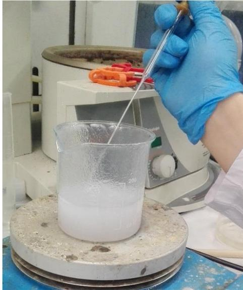
**Figura 2.1:** Aggiunta goccia a goccia della soluzione di precursore di ceria in quella di NaOH.
