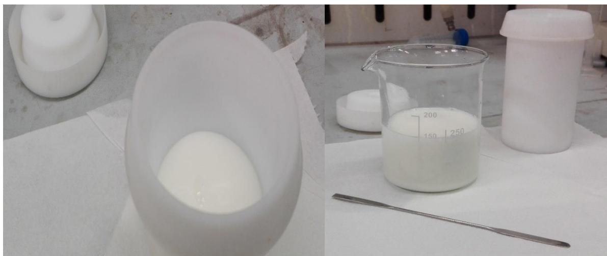
**Figura 2.3:** Soluzione di sintesi in seguito al trattamento idrotermale.
