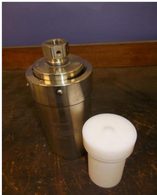
**Figura 2.2:** Autoclave in teflon a destra e suo involucro metallico a sinistra.
