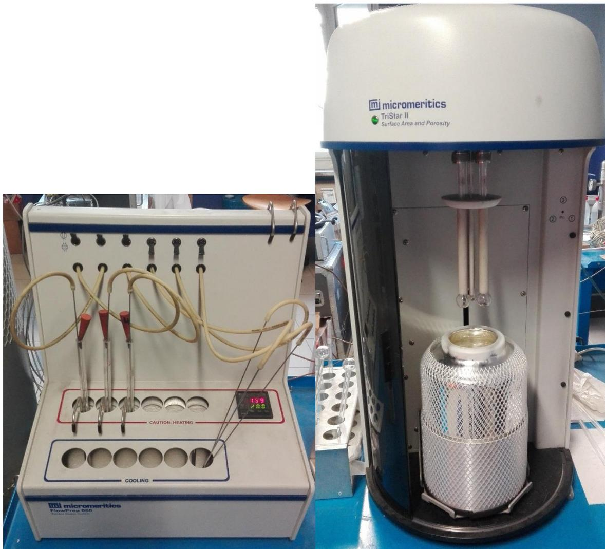
**Figura 3.1:** A sinistra strumento per il pretrattamento. A destra macchina della BET.
