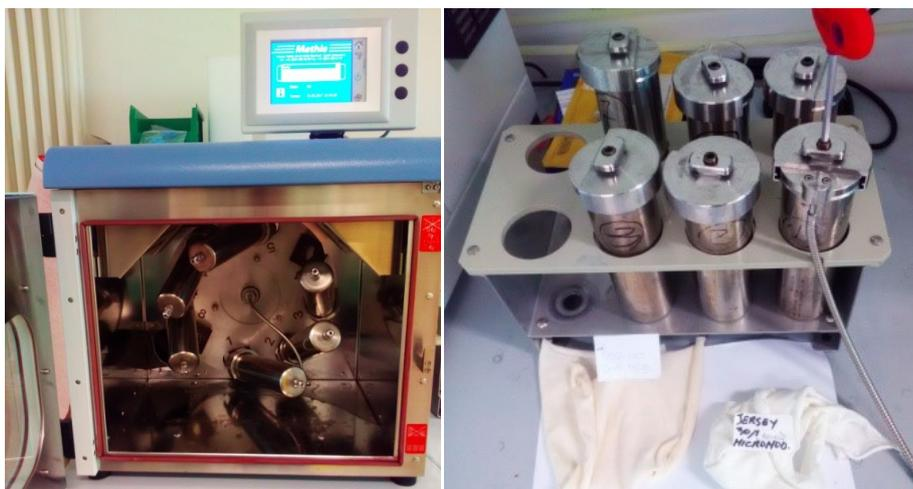
Fig. 2.1 - MathisLABOMAT e relativi cilindri metallici, presso il laboratorio della sede di Biella del Politecnico di Torino
