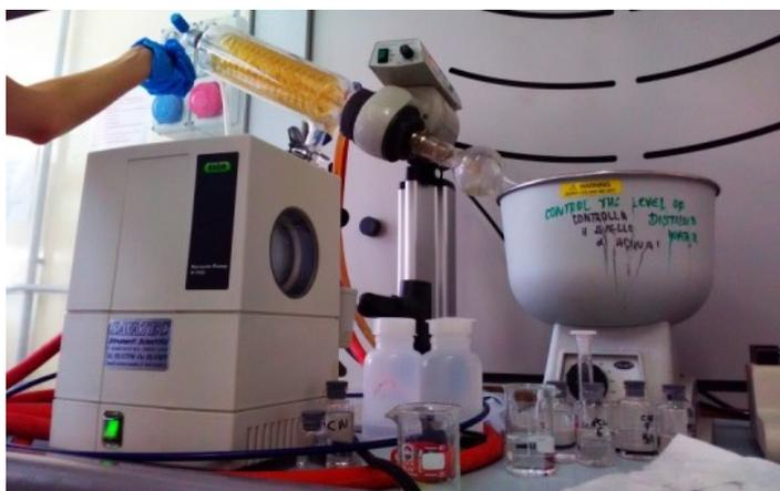
Fig. 1.15 - Rotovapor utilizzato nel laboratorio del Politecnico di Torino
