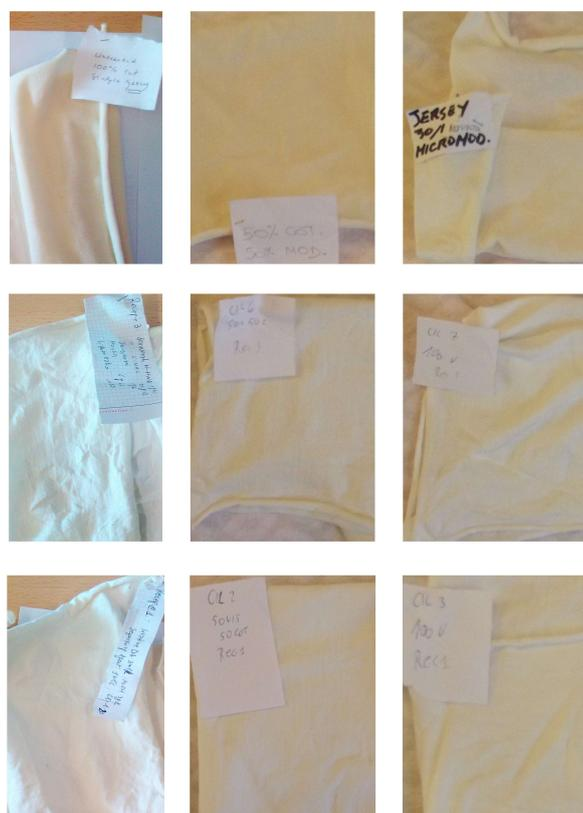
*Fig. 2.2* - In figura sono riportati in alto i tre tessuti di partenza, e in basso gli stessi materiali dopo pretrattamento con la ricetta A (seconda riga) o con la ricetta B (terza riga), e asciugatura - in ordine da sinistra: 100% Cotone, 50% Cotone 50% Viscosa; 100% Viscosa
