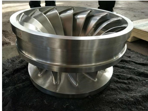
Figura 2.4: Foto girante turbina Francis [6].
