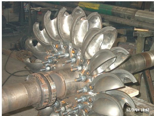
Figura 2.12: Foto della girante turbina Pelton della centrale di Inverso P., concessione di API S.p.a.
