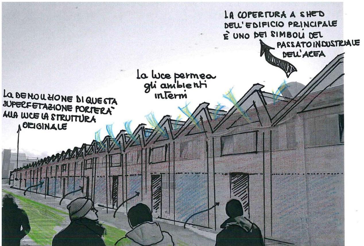
Figura 4.51 – Particolare della copertura a shed del fabbricato principale (A)
