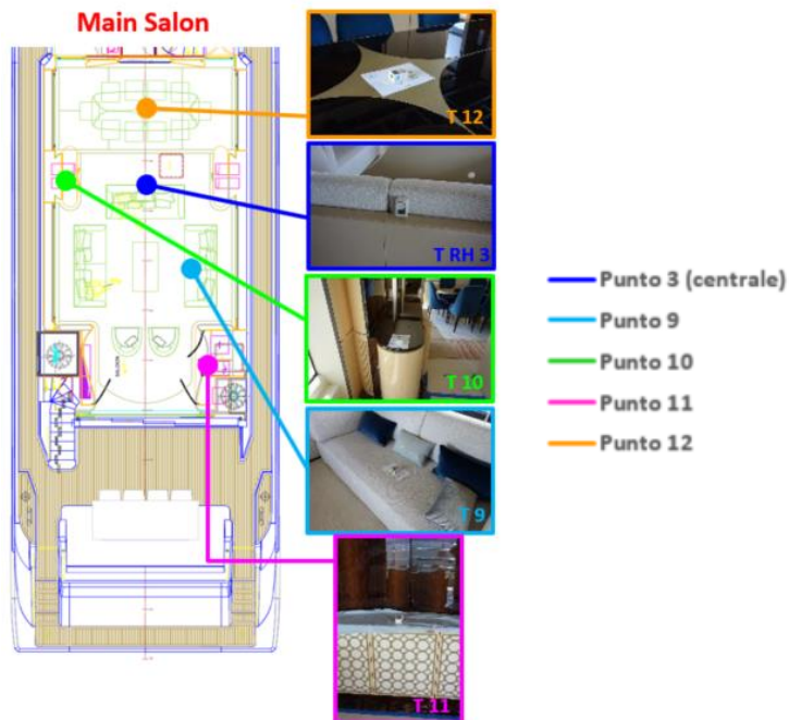
Fig. 3.4.1.2 Posizionamento dei Testo 175 nel main salon
