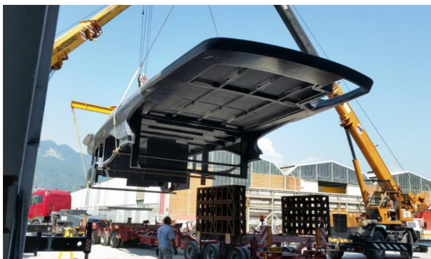
Fig. 2.2.3.1 Sovrastruttura in fibra di carbonio
