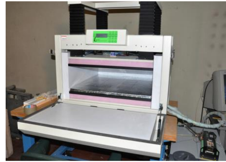
Fig. 3.2.9 Piastra calda Lasercomp FOX600 e schema funzionale
