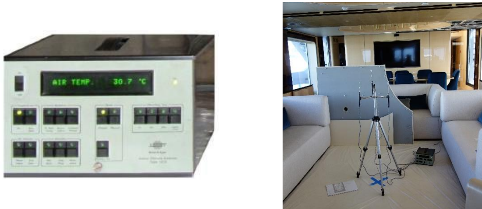
Fig. 3.2.5 Stazione di comfort e posizionamento delle sonde
