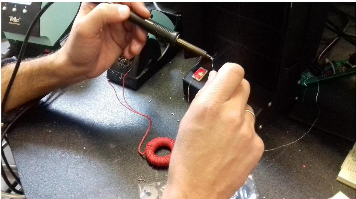
*Figura 30- Saldatura avvolgimenti secondari*
