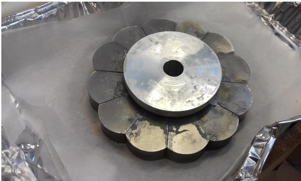
*Figura 84 - Incollaggio del secondo statore*
