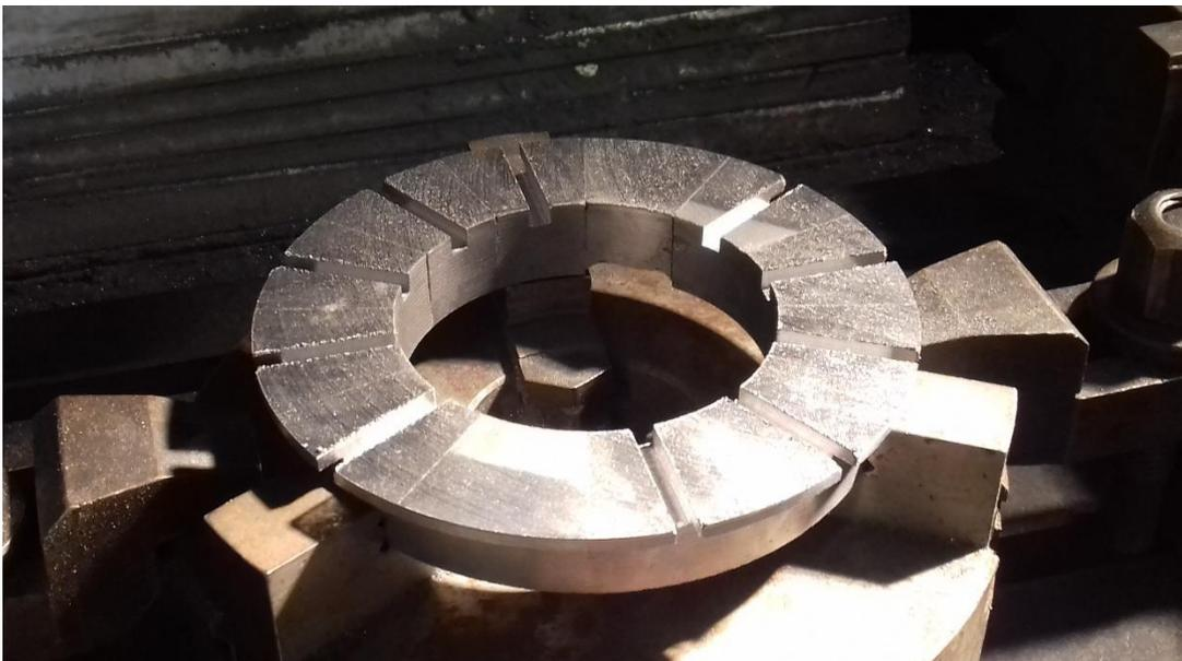
*Figura 82 - Fresatura delle aperture di cave*
