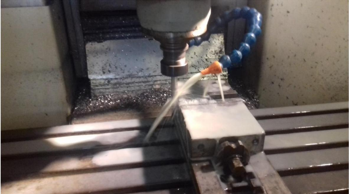
*Figura 50 - Fresatura del provino 4 Ferro+ Fenolica 0,2%*
