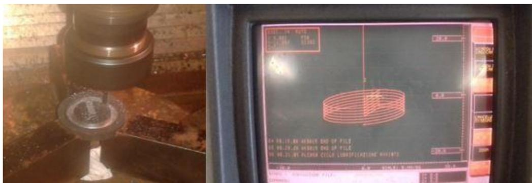
*Figura 24 - Fresatura campione Somaloy e schermo fresa con controllo automatico del processo*
