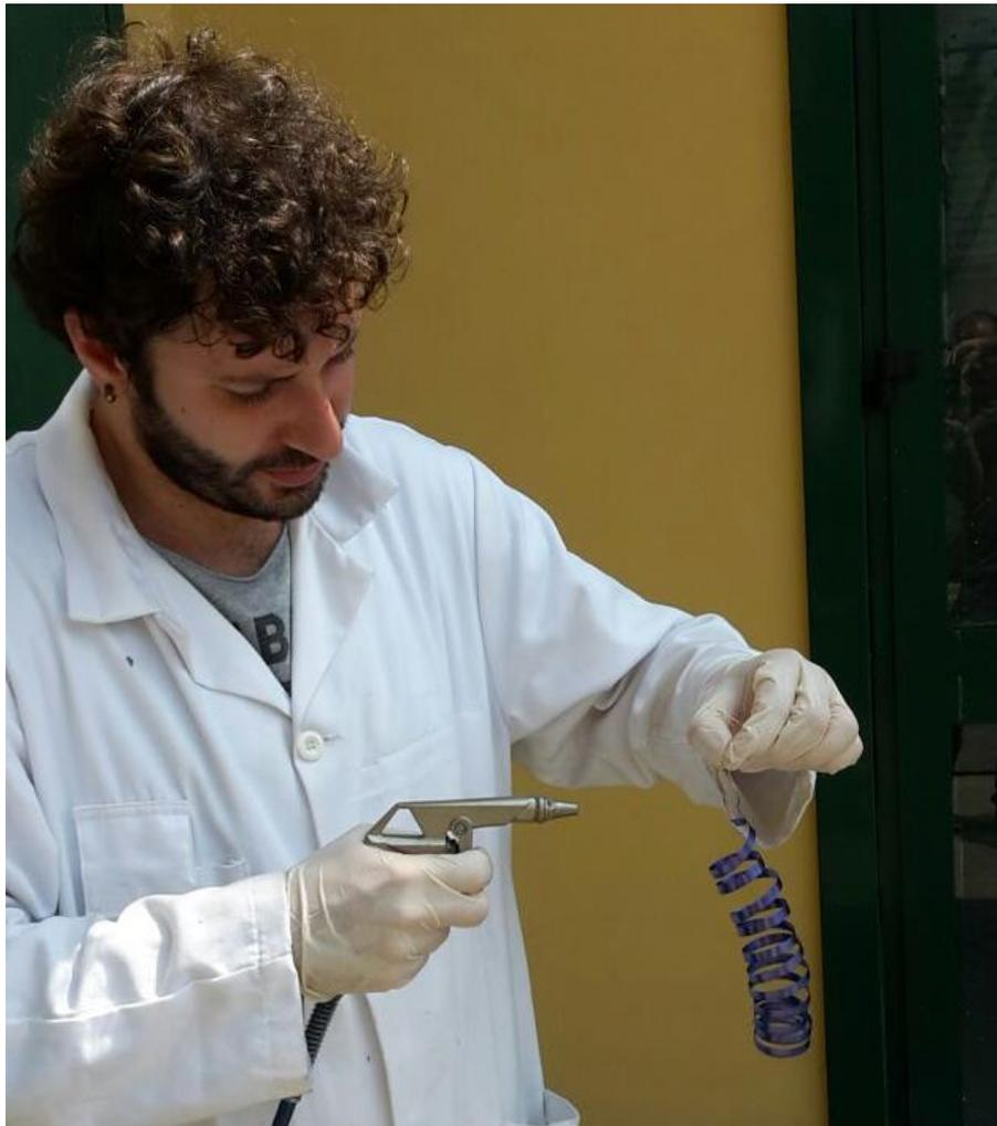
*Figura 105 - Asciugatura delle bandelle con compressore*
