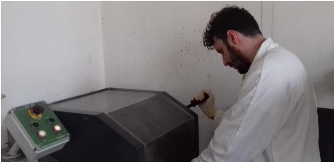
*Figura 61- Taglio del campione B8.3 AFM I*
