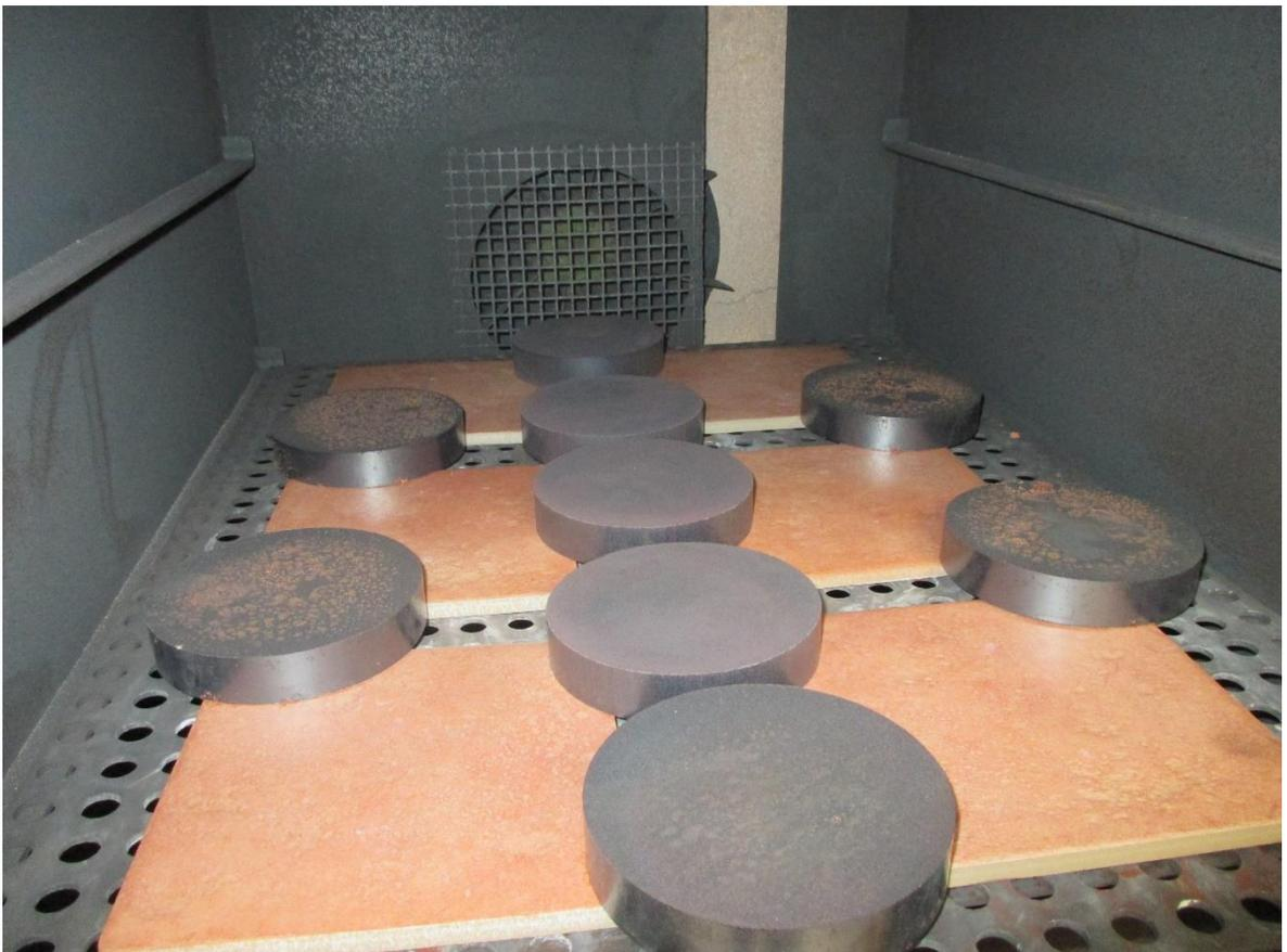
*Figura 45- Dischi a fine trattamento termico*
