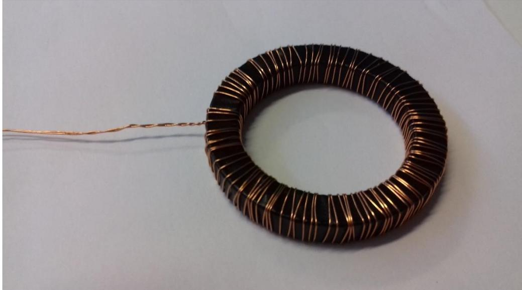
*Figura 26-Avvolgimento secondario con filo di rame di 100 spire*
