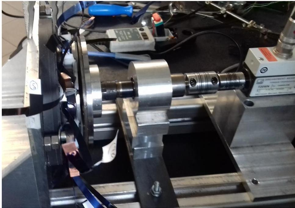
*Figura 113 - Banco prova per la cogging torque con statore montato*
