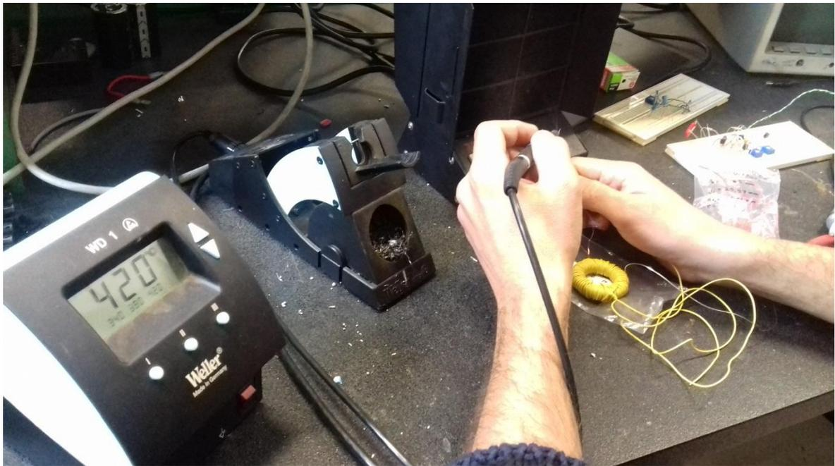
*Figura 29- Saldatura a stagno degli avvolgimenti secondari*
