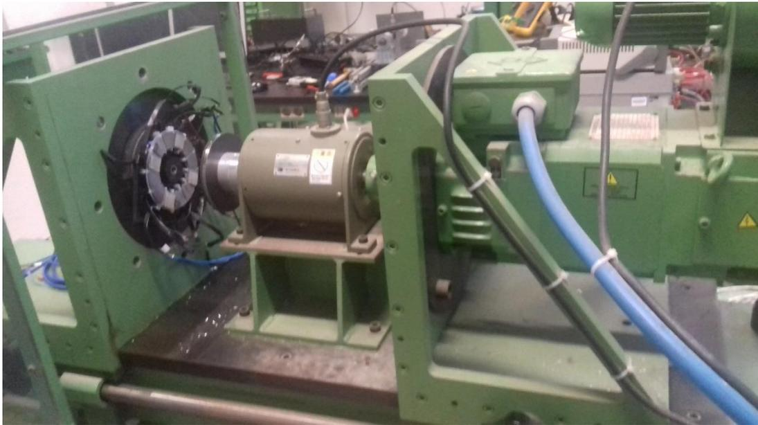
*Figura 123 - Statore e rotore montati sul banco prova*
