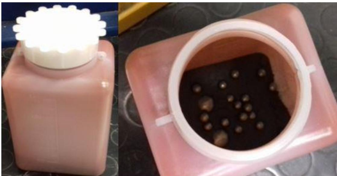
*Figura 36- Preparazione delle polveri da miscelare con sfere di acciaio*
