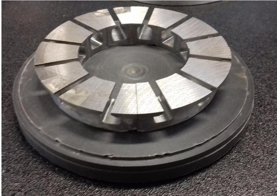
*Figura 98 - Statore incollato con colla acrilica su supporto di materiale poliacetalico*
