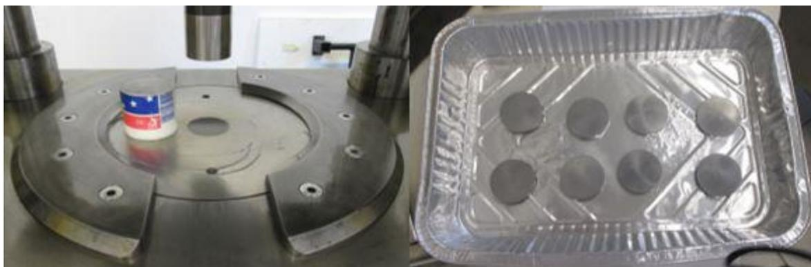
Figura 17- Pressa a freddo delle polveri Somaloy(sinistra) e campioni cilindrici
