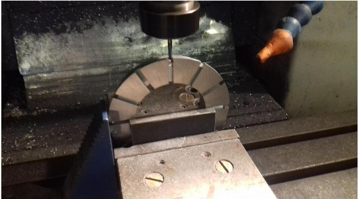
*Figura 85 - Fresatura finale delle cave*
