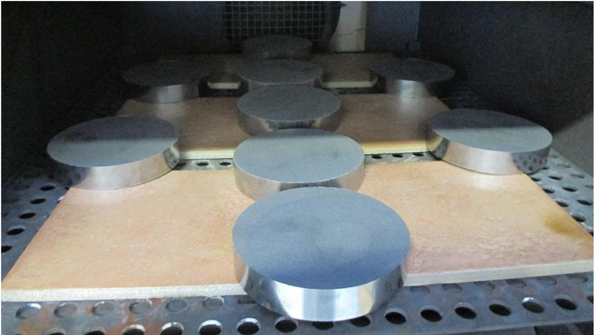
*Figura 44 - Dischi pressati e inseriti nel forno per il trattamento termico*
