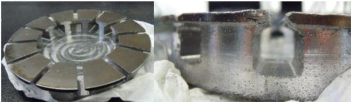
*Figura 14 - Prototipo di partenza: statore realizzato con polveri commerciali*
