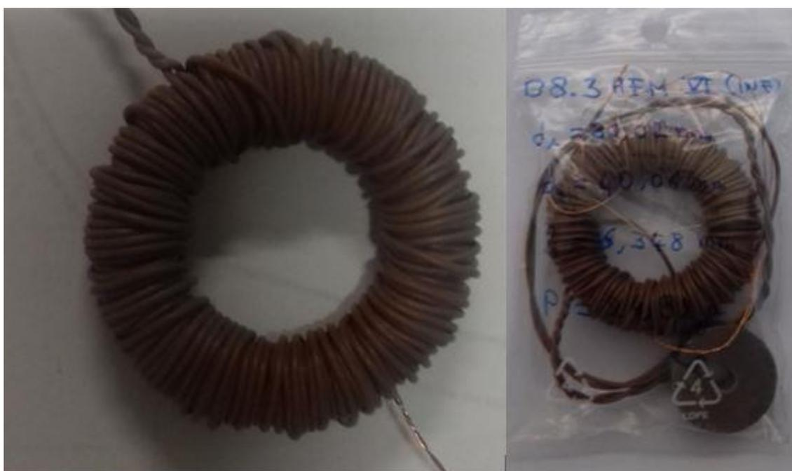
Figura 28- Campione completo di avvolgimento primario e secondario
