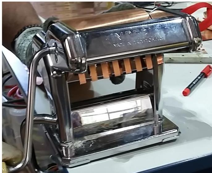
*Figura 99 - Taglio delle bandelle da rotolo di rame*
