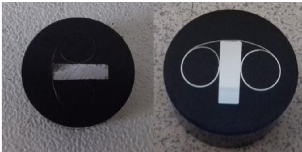
*Figura 68 - Campione inglobato nella resina termoidurente*
