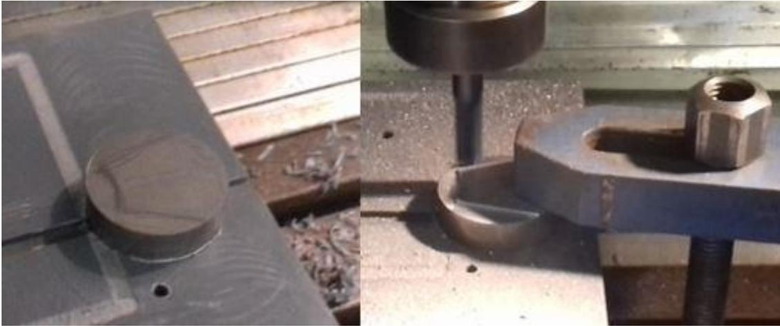
*Figura 75- Prima fresatura dei cilindri*
