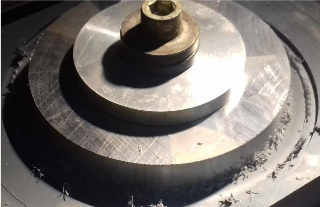
*Figura 81 - Fresatura del diametro esterno*
