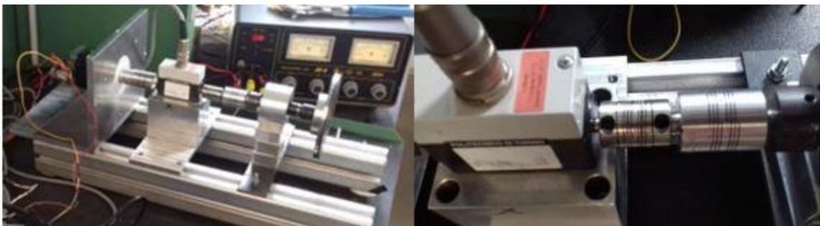
Figura 112 - Banco prova per la misura di cogging torque (sinistra), torsionometro e giunto elastico (destra)
