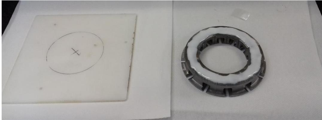
*Figura 96 - Lastra in PA6 (sinistra) e statore da incollare con colla epossidica*
