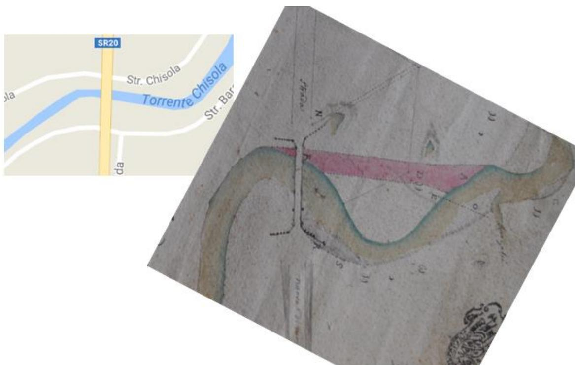
**Figura 2, carta del 1766 che mostra la rettifica del Chisola lungo il ponte di strada Carignano, in prossimità del quale si è verificata l'esondazione per collasso arginale nel 2016. Su concessione dell'archivio storico di Moncalieri. Divieto di ulteriore riproduzione senza la concessione dell'archivio.**
