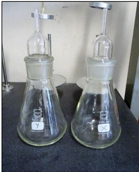
*Fig. 26 Pycnometers*
