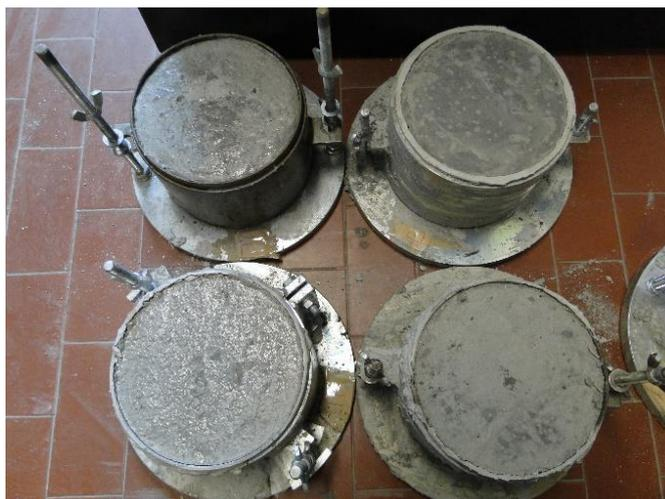
**Figura 4.14** – campioni per la prova CBR.
