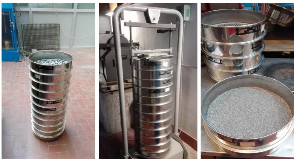
**Figura 3.4** – fasi della setacciatura in laboratorio.
