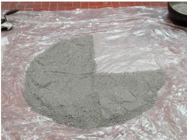
**Figura 3.3** - operazione di quartatura del sabbione 0-8 mm.
