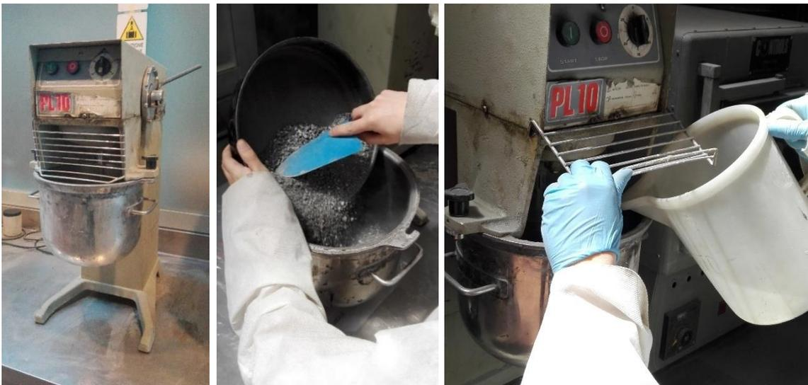
**Figura 4.1** - fasi della preparazione delle miscele in laboratorio.
