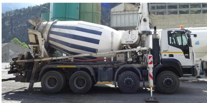
**Figura 4.2** – camion betoniera utilizzato per la miscelazione dei componenti.
