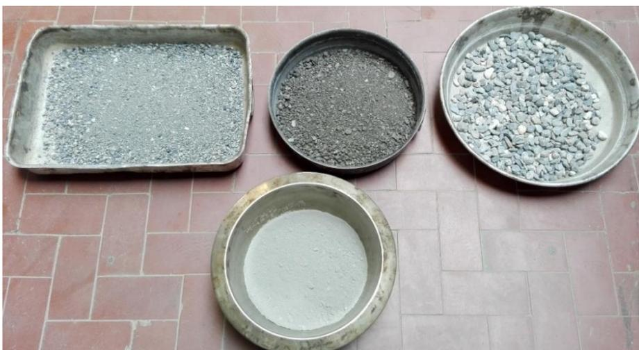
**Figura 3.2** – In alto, da sinistra verso destra: sabbione, fresato, ghiaia. In basso: limo.
