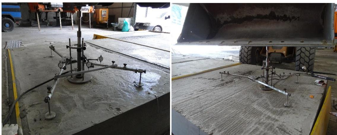
**Figura 4.23** – prova di carico su piastra.
