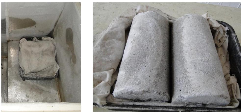
**Figura 4.18** – provini sottoposti a cicli di gelo e disgelo.
