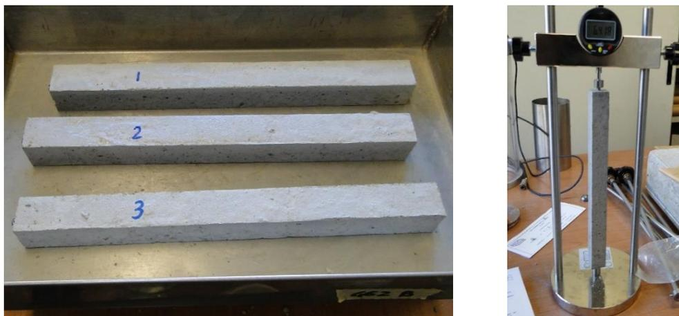
Figura 4.19 – provini ed apparecchiatura per la prova di ritiro.
