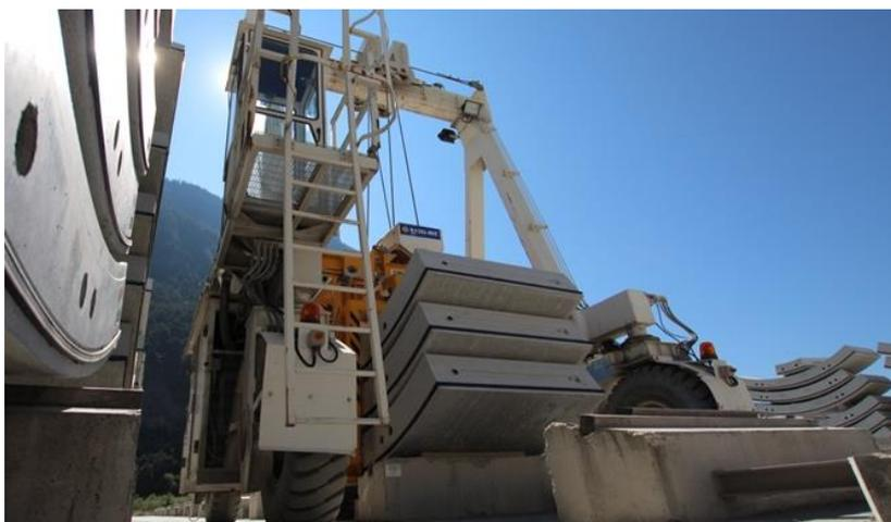
**Figura 1.3** - conci dell'anello di rivestimento del tunnel.
