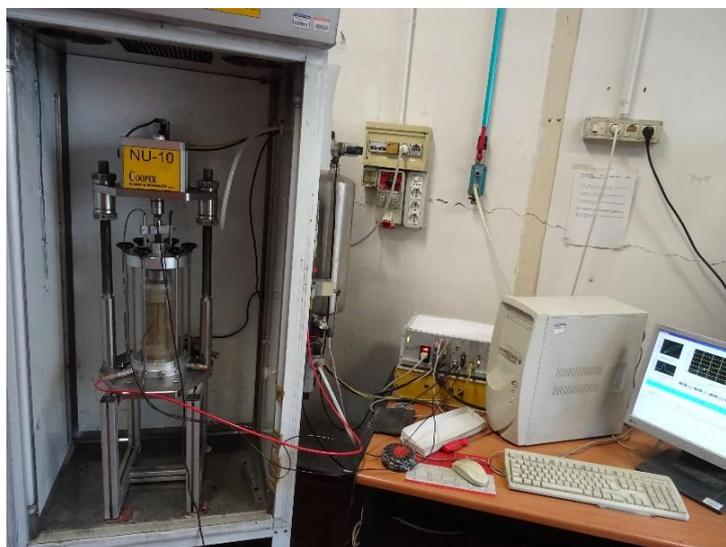
**Figura 4.9** - apparecchiatura della prova in cella triassiale a carico ripetuto.
