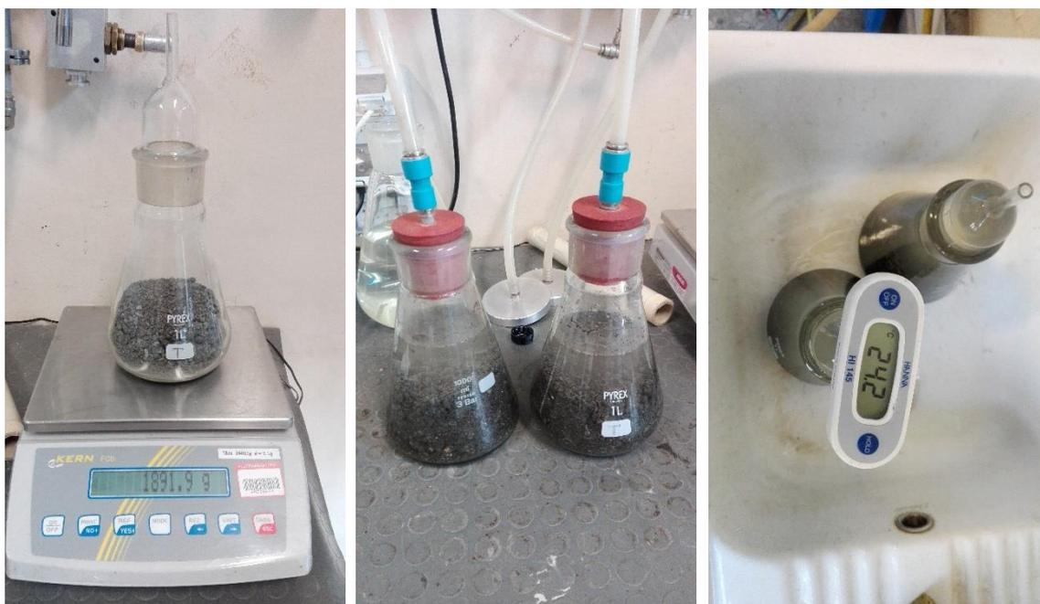
**Figura 3.7** – fasi della determinazione della massa volumica (metodo picnometro).
