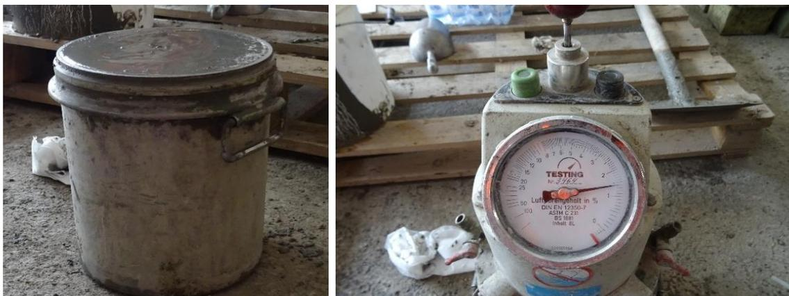
Figura 4.22 – misura del contenuto d’aria con il porosimetro.
