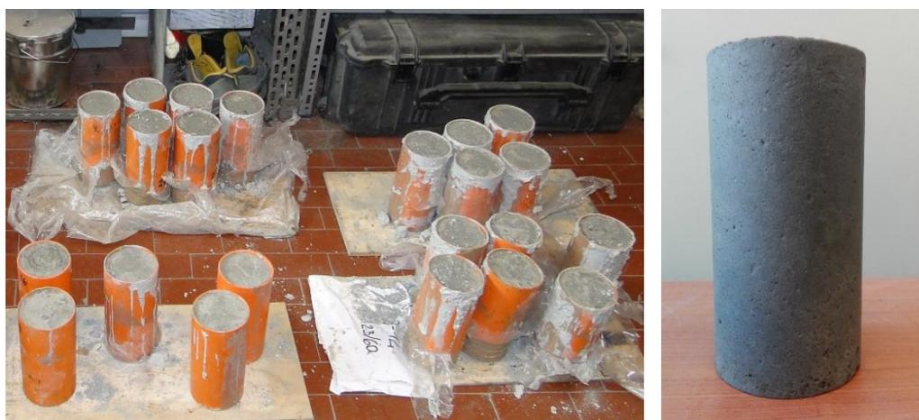
Figura 4.13 – campioni per la prova in cella triassiale a carico ripetuto.
