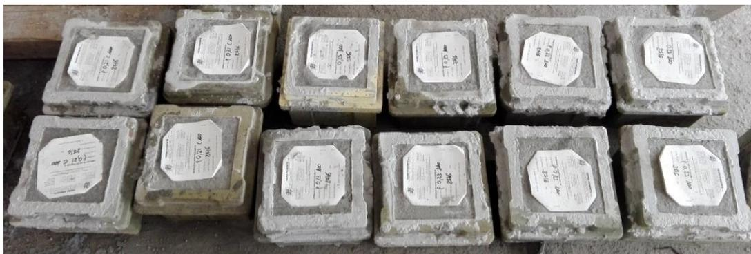
Figura 4.16 – provini cubici destinati alla prova di compressione.
