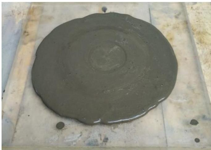
**Figura 3.10** - prova di spandimento della miscela di acqua e polvere con a/p 0,7 e dosaggio additivo 0,5%.
