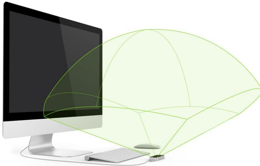
**Figura 34.** Area di interazione del Leap Motion collegato a un computer. (fonte: [www.leapmotion.com](http://www.leapmotion.com))
