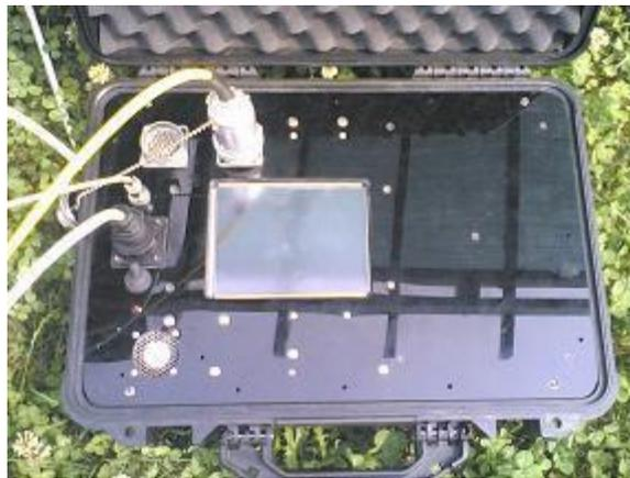
**Figura 37. Sismografo (Cavagnino, 2016)**
