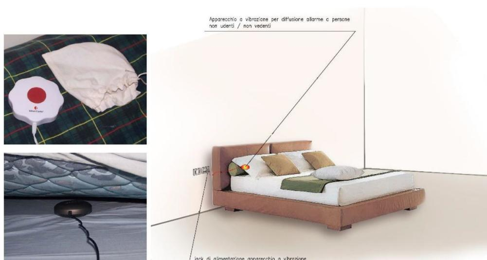
Figura 5.9: Apparecchio di vibrazione per diffusione allarme per persona non vedente/non udente
