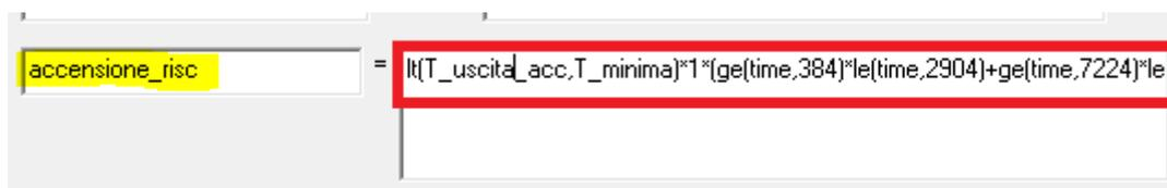
Figura 97 – definizione di una parte della sintassi del controllo che regola l'accensione della caldaia o pdc, effettuando dapprima un controllo preliminare sull'ora della simulazione e sulla temperatura della mandata dell'impianto
