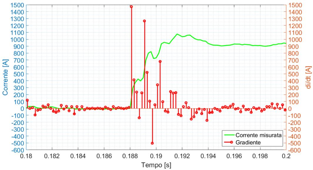
Figura 4.31. Pendence del segnale fornito, con disturbo
