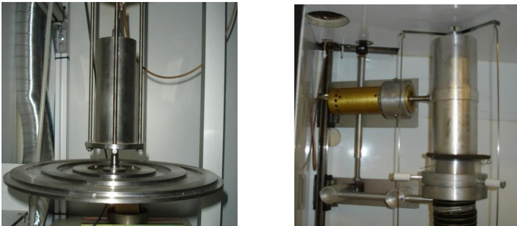
Figura 1.3.2 : trasduttore SPR a sinistra, trasduttore CR a destra (figura tratta da Carcel et al., 2014, con modifiche).
