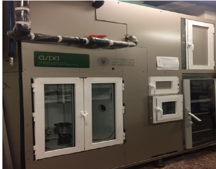
Figura 2.5: Impianto di liofilizzazione utilizzato in questo lavoro, laboratorio gruppo ASPA.
