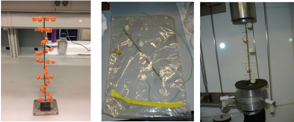
Figura 2.6: immagine a sinistra: campioni fissati sul supporto metallico, immagine centrale: campioni pronti per la fase di congelamento, immagine a destra: supporto metallico all'interno della camera di essiccamento.
