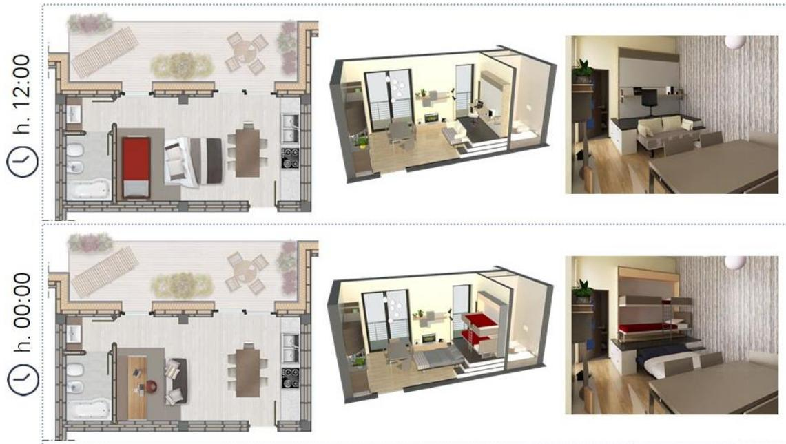
Fig.2. Esempio di un modulo abitativo, con la differenziazione dell'uso degli spazi a seconda dell'orario. Da sinistra a destra, Pianta, spaccato tridimensionale, render interno.
