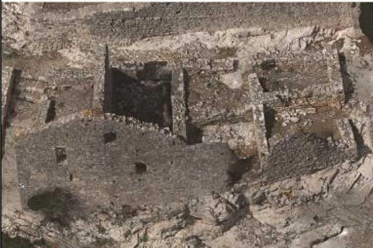
Elaborazione della mesh texturizzata ottenuta in 3DReshaper con viste di dettaglio del modello digitale navigabile realizzato dalle immagini dei voli effettuati con l'esacottero.
