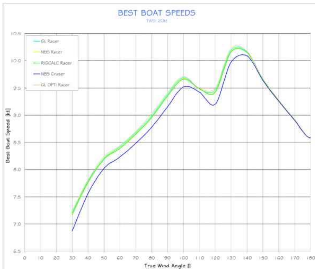
Best Boat Speeds – le diverse velocità sviluppate dall'imbarcazione con i rig progettati, in funzione degli angoli di un vento reale con intensità di 20 nodi
