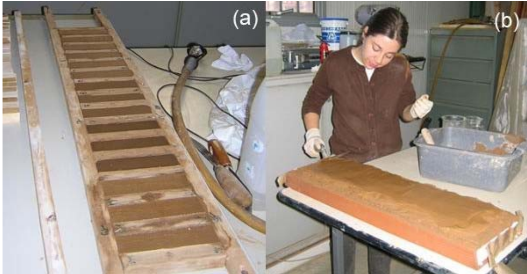
(a) Confezionamento dei provini di intonaco 2x3x12cm; (b) Applicazione dell'intonaco in tre strati su supporto in laterizio
