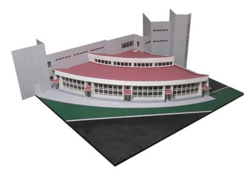
Le ciel artificiel permet d'effectuer des évaluations quantitatives : les données relevées par des sondes luxmétriques sont utilisées pour représenter les différents niveaux de lumière au moyen de courbes isovaleur en plan et de tendances en section et dans le temps.
