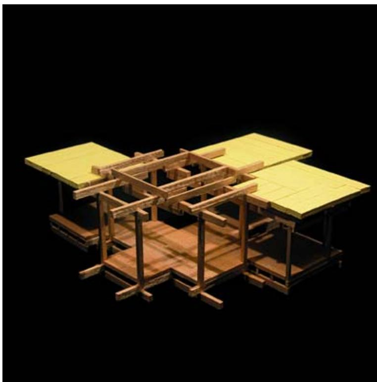
Il progetto è costituito da tre elementi modulari; il nocciolo centrale di 22 mq a pianta cruciforme, è destinato ad accogliere le funzioni abitative della zona giorno e quelle impiantistiche relative alla cucina e al bagno, mentre gli elementi stanza sono di pianta quadrata rispettivamente di 13 mq per quella ad angolo e di 10.5 mq per quella ortogonale.
