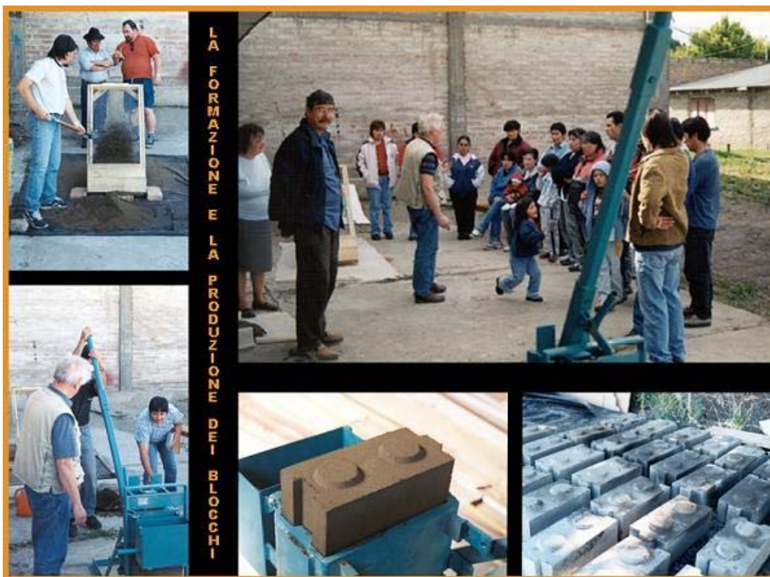
Fig.2. Il corso di formazione e la produzione dei blocchi sagomati tipo “Mattone”
