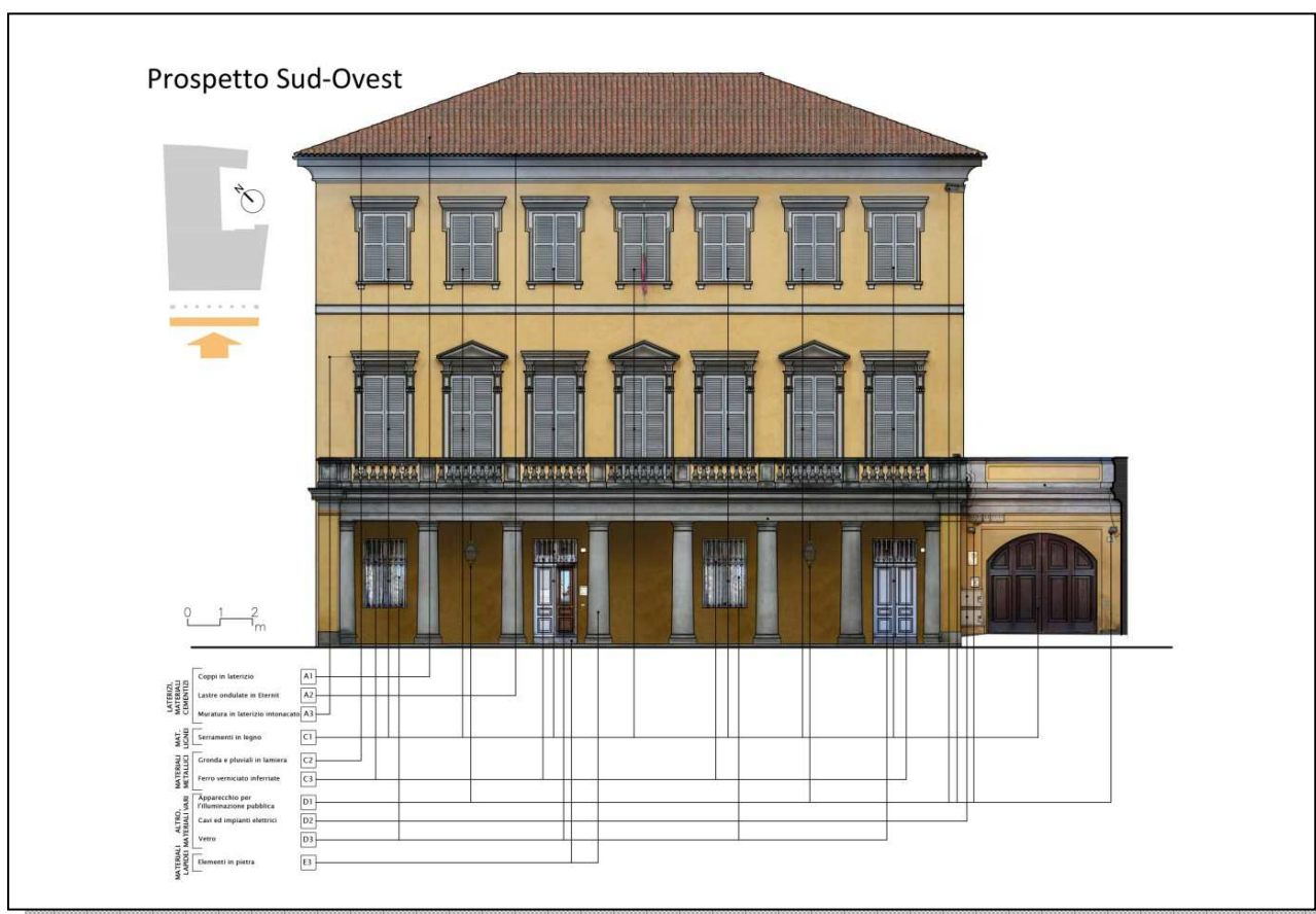
Immagine 1: Mappatura dei materiali sul prospetto principale di Palazzo Garrone
