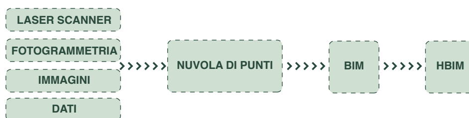
Figura 95: schematizzazione processo per modello HBIM (fonte: elaborazione personale)
