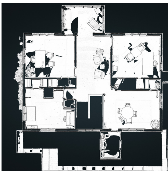
Figura 79: piano primo modello RTC360 (fonte: screenshot Potree Viewer)
