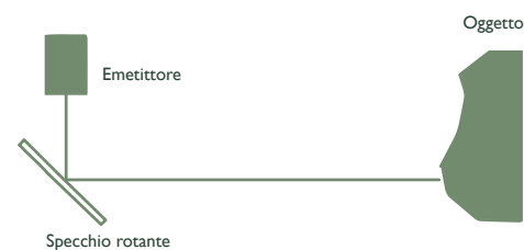
Figura 30: scanner distanziometrici - TOF (rielaborazione personale)
