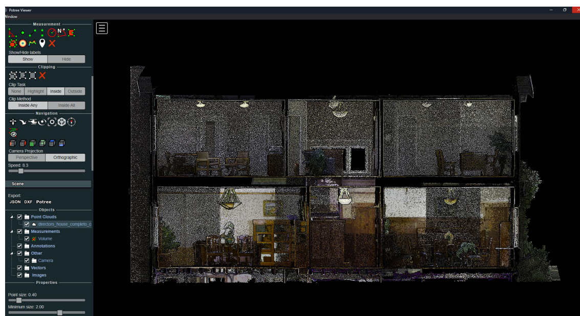
Figura 70: sezione del modello 3D completo (fonte: screenshot Potree Viewer)
