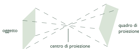
Figura 41: proiezione centrale (fonte: rielaborazione personale)
