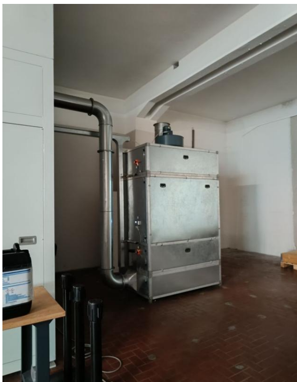
Figura 27 – cono ottico n°4: Laboratori Mavel, macchinario A, impianto destinato alla verniciatura dei componenti dei motori elettrici.
