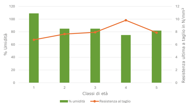
Grafico 5. Valori di taglio in funzione del contenuto di umidità, rielaborazione propria, Data source: Il bamboo come materiale da costruzione: Caratteristiche fisiche e meccaniche, tecnologie costruttive
