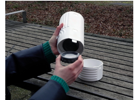
Inserire la cialda: per prima cosa, inserire la cialda ESE nel portacialda e chiuderlo per fissare la macchina.
