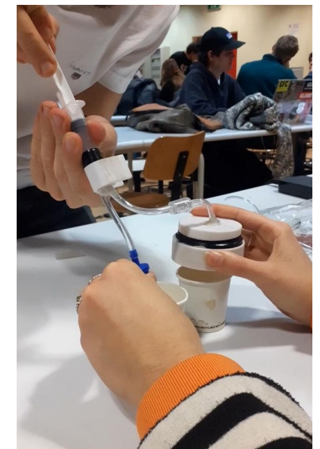
A sinistra: sollevamento di un peso di 9 kg, raggiungendo così 9 bar con una siringa. A destra: impianto idrico con valvole unidirezionali.
