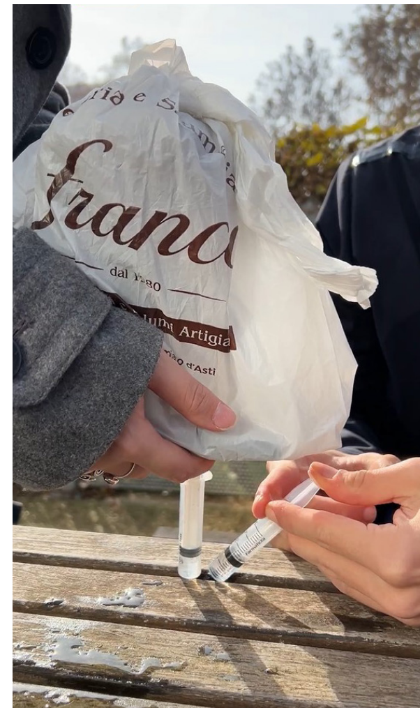
A sinistra: sollevamento di un peso di 9 kg, raggiungendo così 9 bar con una siringa. A destra: impianto idrico con valvole unidirezionali.
