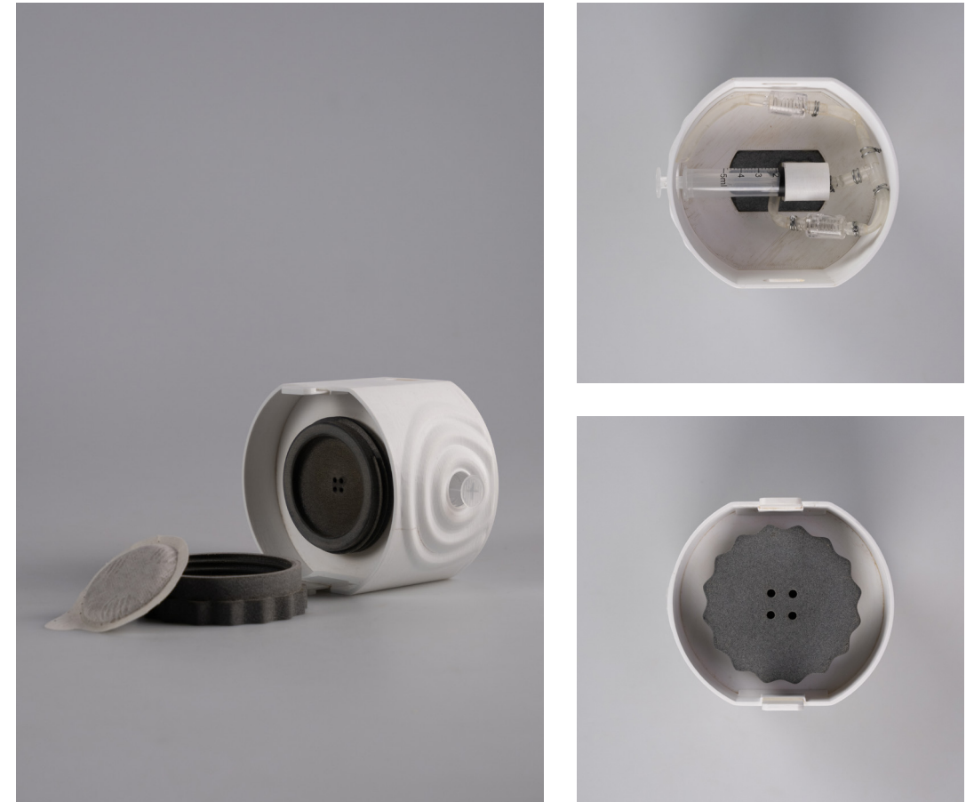
A sinistra: il porta cialde aperto con una cialda ESE. In alto a destra: l'interno del secondo modulo, con i tubi in silicone. In basso a destra: il porta cialde chiuso visto dal basso.
