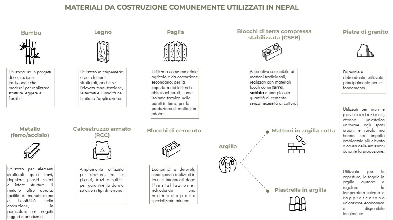
Figura 81. "Materiali da costruzione utilizzati in Nepal". Fonte: Bodach (2014), Nepal School Project. Rielaborazione dell'autore della tesi. <https://doi.org/10.1016/j.enbuild.2014.06.022>
