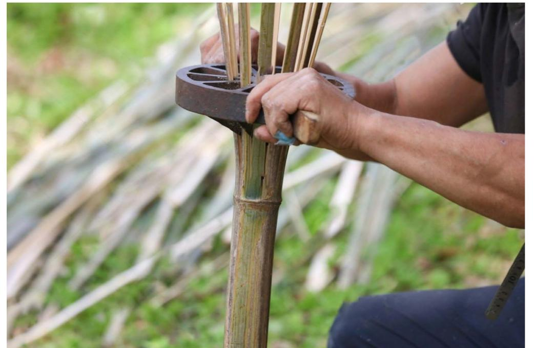
Figura 66. "Bamboo Splitter". Fonte: Immagine web
