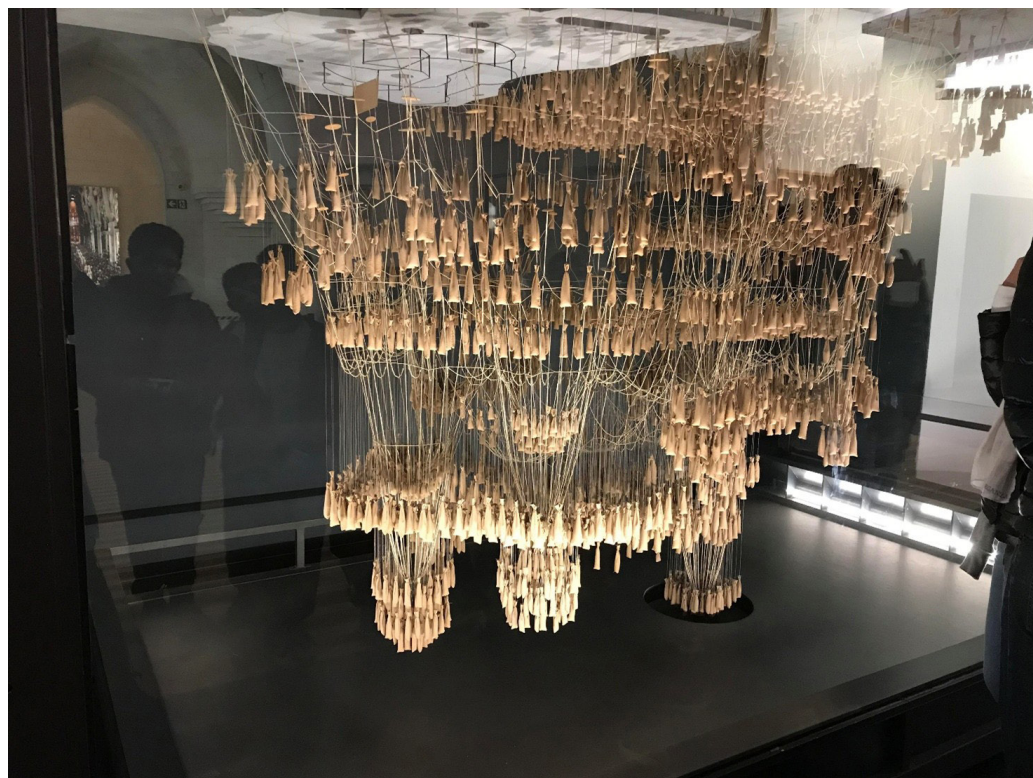
Fig. 2 Modello funicolare della Sagrada Família
