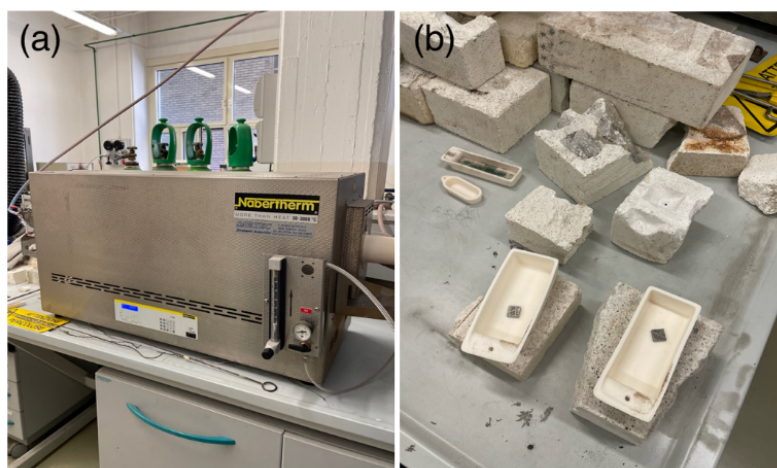
Figura 20: Forno tubolare (a); navicelle per l'inserimento campioni (b).
